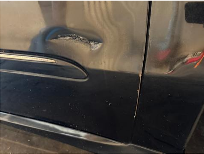
Beifahrertür (Spaltmaße ungenau, Kratzer, Lackschaden, Delle, Unsachgemäß instand gesetzt)
