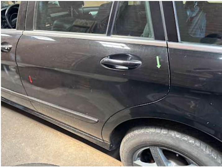
Türe hinten links (Delle)
