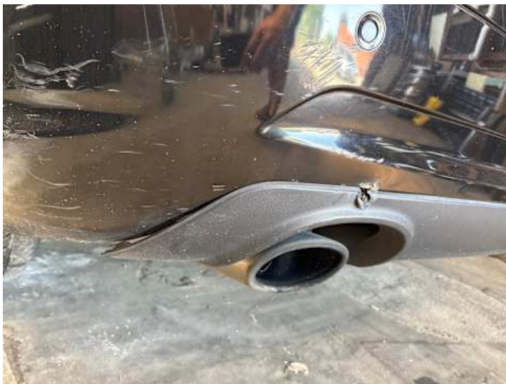
Stoßstange hinten (Kratzer, Spaltmaße ungenau, Riss/Bruch)
