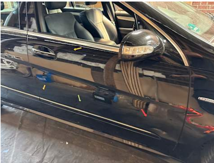
Beifahrertür (Kratzer, Lackschaden, Delle, Spaltmaße ungenau)
