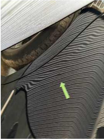
Türe hinten rechts (Delle)
