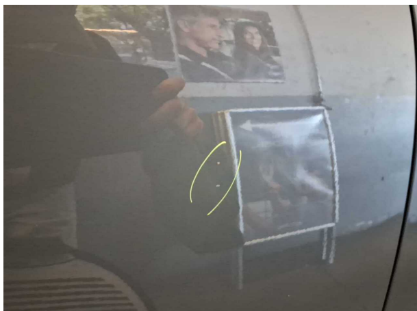
Beschädigung 3: Tür hinten rechts: Tür - verkratzt / verschürft - auslegen / polieren
