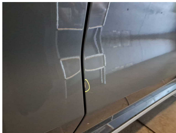
Beschädigung 4: Tür vorn rechts: Türkante - verkratzt / verschürft - auslegen / polieren
