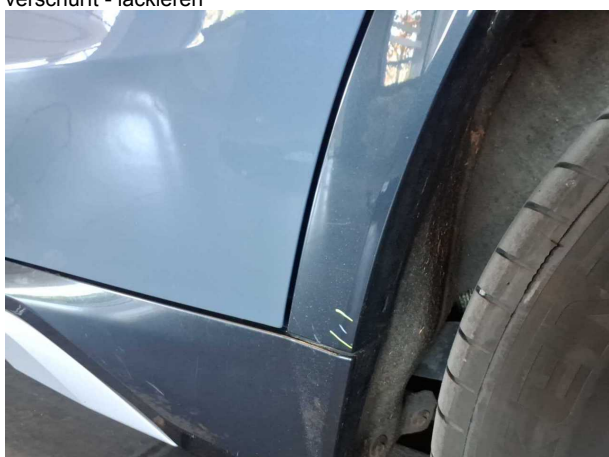
Gebrauchsspur 2: Seitenwand links: Radlauf - Kratzer - kein Abzug
