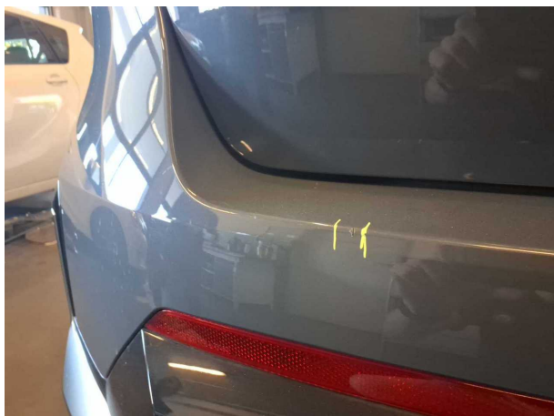
Beschädigung 9: Stossfänger hinten: Stossfänger hinten (Ladekante verkratzt) - Smart Repair
