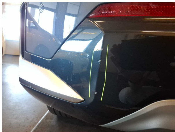
Beschädigung 10: Stossfänger hinten: Spoiler - verkratzt / verschürft - lackieren
