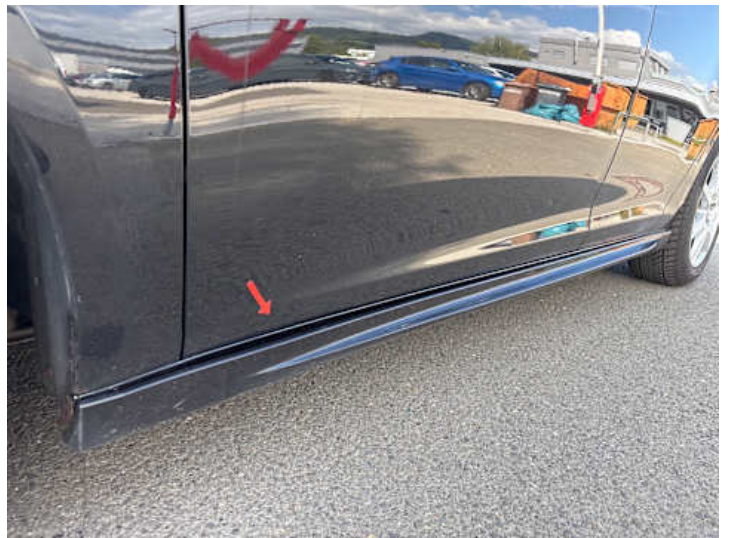
Schweller links (Riss/Bruch)
