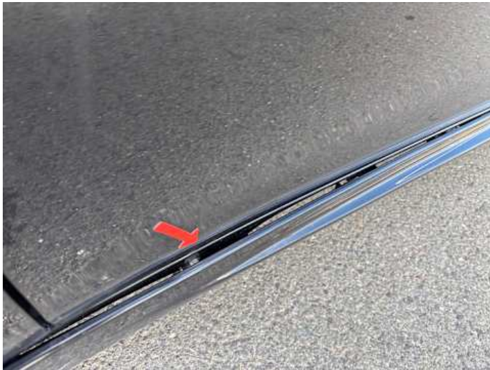
Schweller links (Riss/Bruch)
