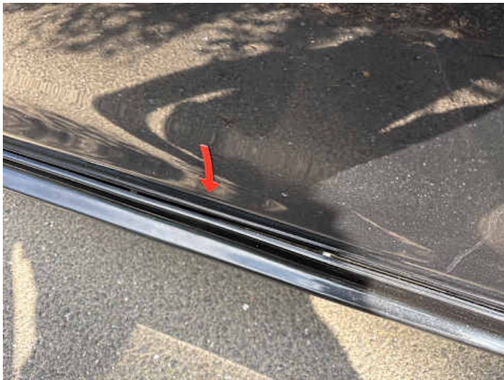
Schweller rechts (Riss/Bruch)
