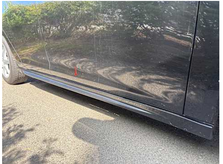
Schweller rechts (Riss/Bruch)
