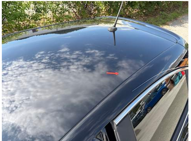
Dach (Delle, Kratzer)
