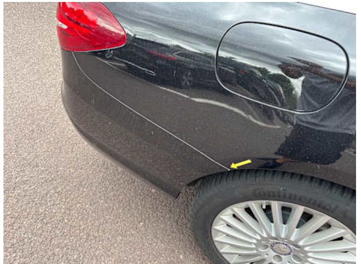
Stoßstange hinten (Kratzer, Spaltmaße ungenau)
