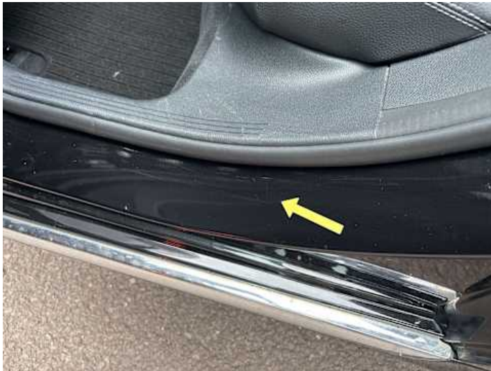
Türe hinten links (Kratzer)
