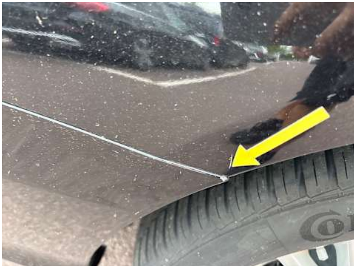
Stoßstange hinten (Kratzer, Spaltmaße ungenau)
