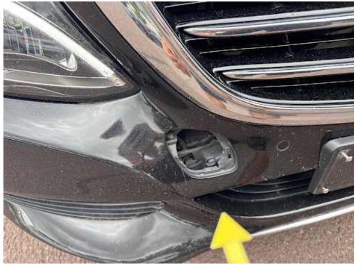
Stoßstange vorne (Anderer Schaden): Bauteil fehlt
