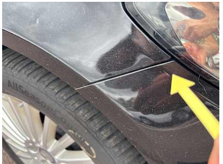
Stoßstange vorne (Spaltmaße ungenau)
