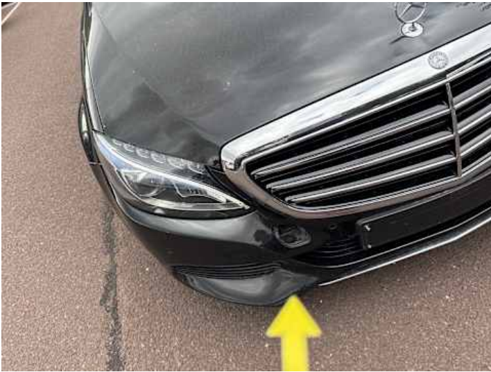
Stoßstange vorne (Anderer Schaden): Bauteil fehlt
