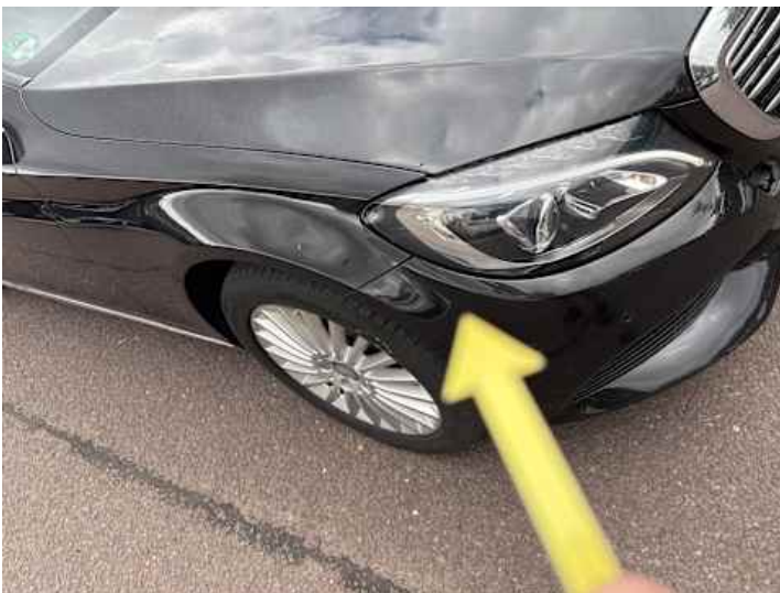
Stoßstange vorne (Spaltmaße ungenau)
