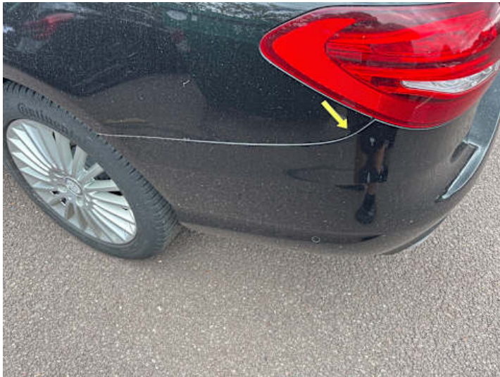
Stoßstange hinten (Spaltmaße ungenau)
