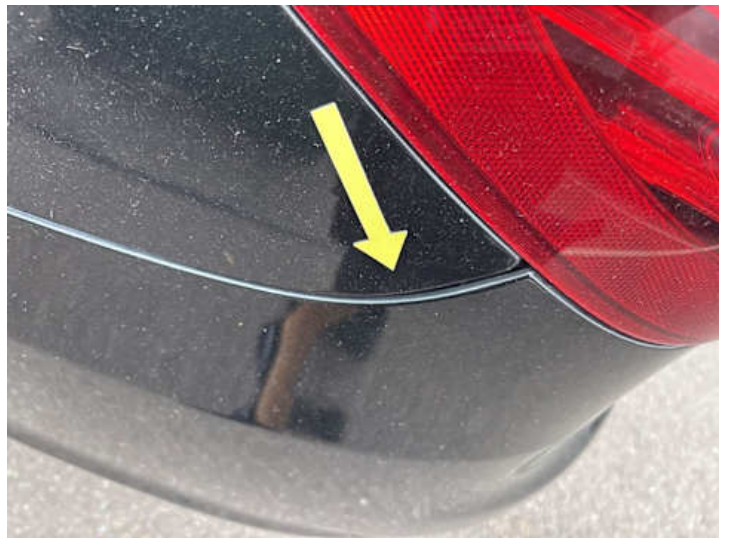
Stoßstange hinten (Spaltmaße ungenau)
