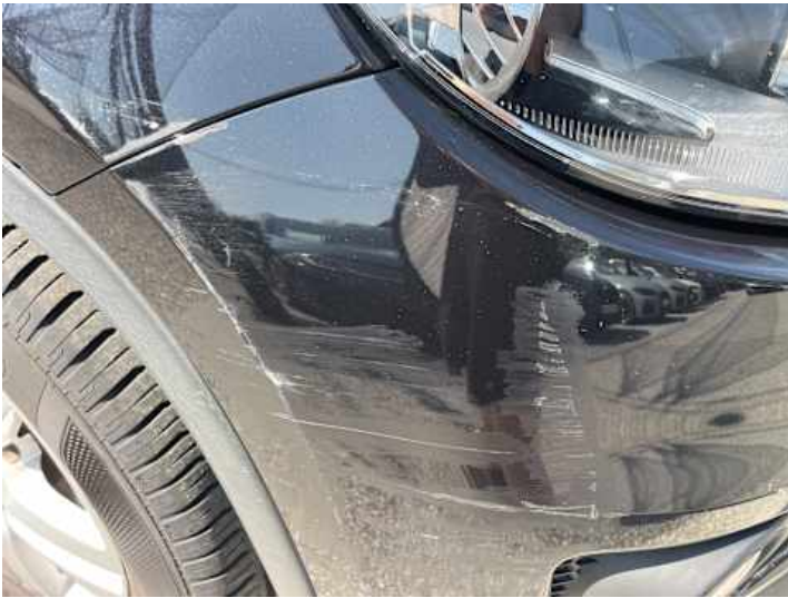
Stoßstange vorne (Kratzer, Lackschaden, Unsachgemäß instand gesetzt)
