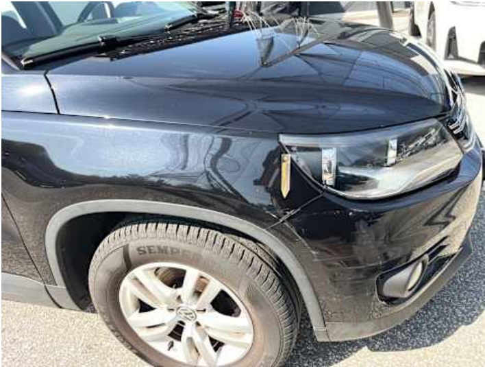
Kotflügel vorne rechts (Kratzer, Lackschaden)
