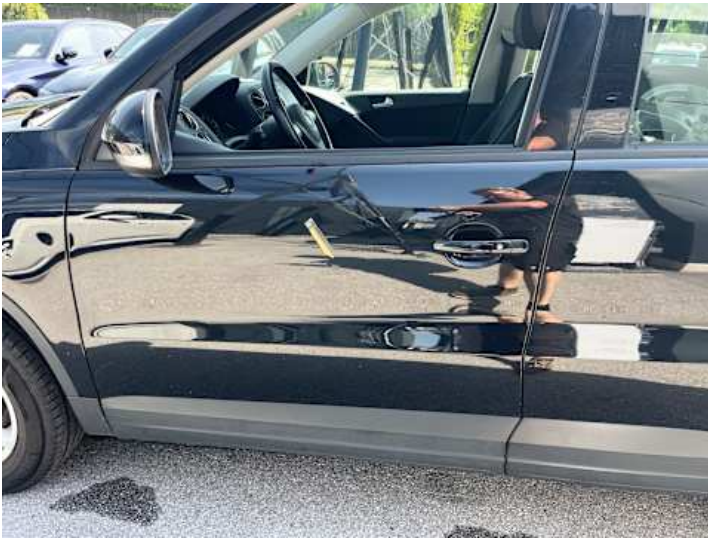
Fahrertür (Lackschaden, Unsachgemäß instand gesetzt)
