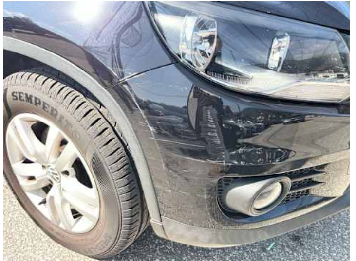
Stoßstange vorne (Kratzer, Lackschaden, Unsachgemäß instand gesetzt)
