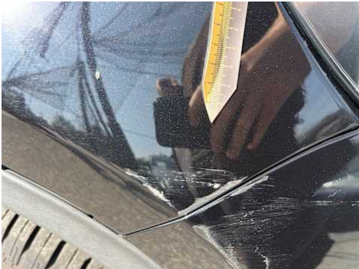
Kotflügel vorne rechts (Kratzer, Lackschaden)
