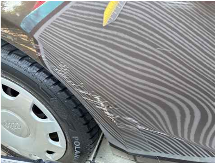
Seitenteil hinten rechts (Verformung)
