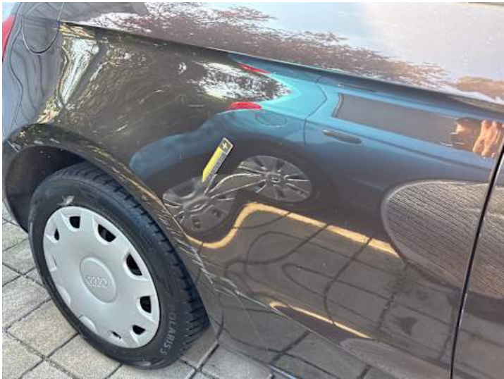
Seitenteil hinten rechts (Verformung)
