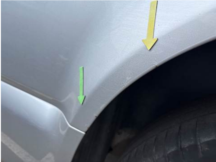
Seitenteil hinten rechts (Rost)
