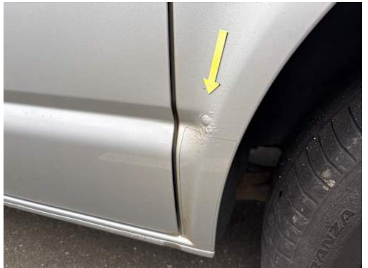
Seitenteil hinten links (Rost)
