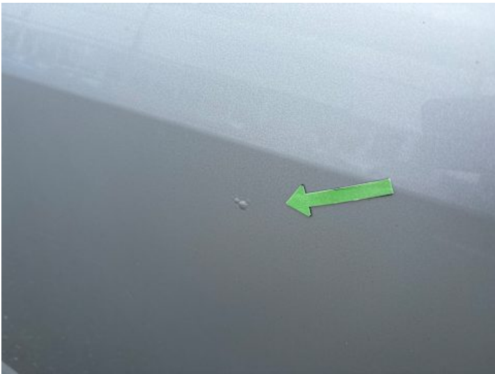
Türe hinten links (Rost)
