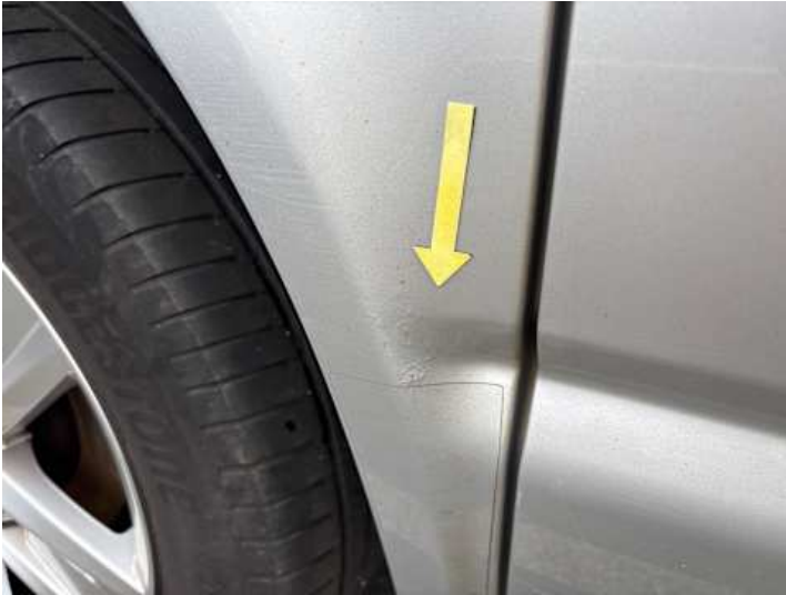
Seitenteil hinten rechts (Rost)
