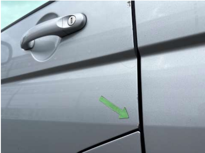
Fahrtür (Rost, Lackschaden)
