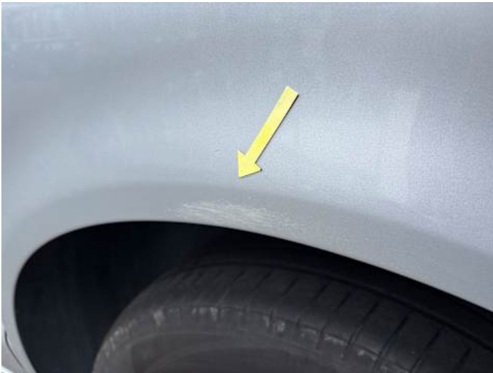
Seitenteil hinten links (Lackschaden)
