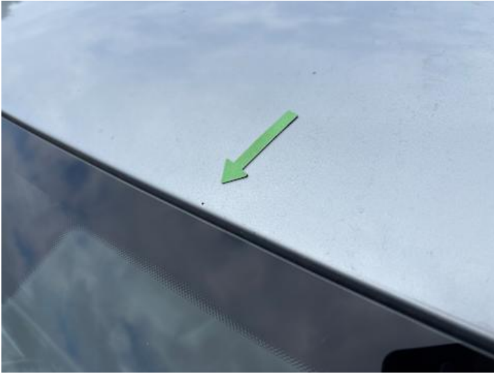
Dach (Steinschlag, Rost)
