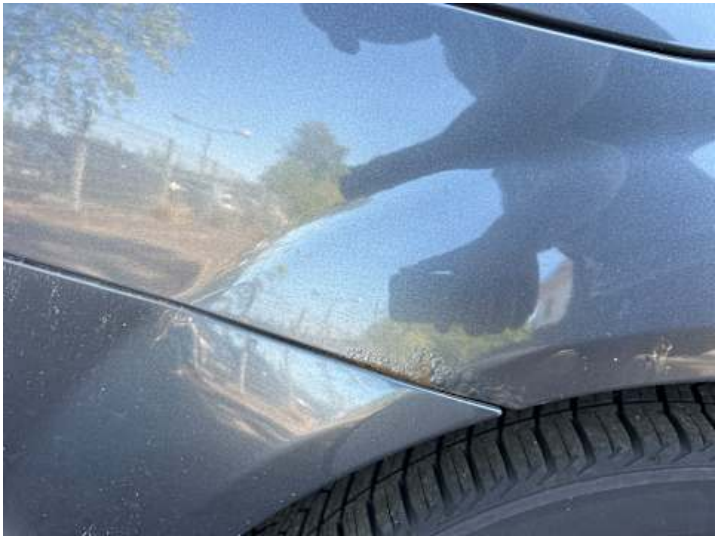
Seitenteil hinten rechts (Rost)
