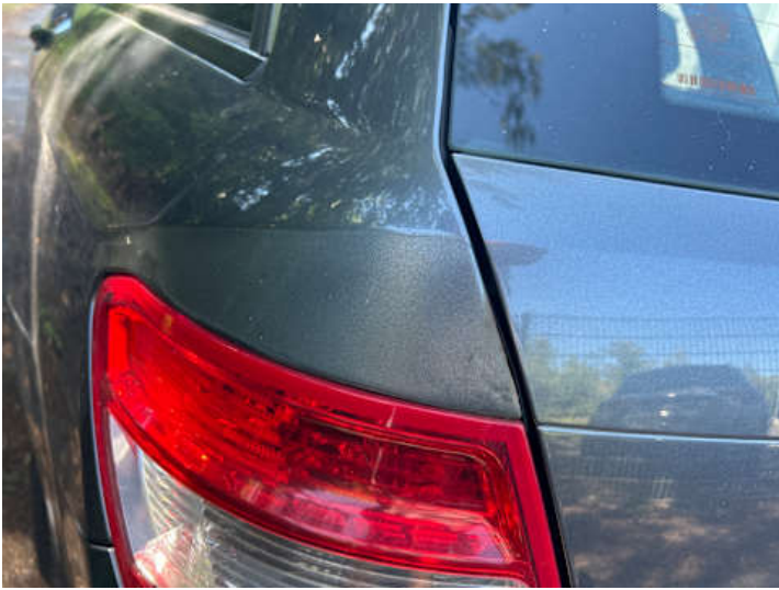
Seitenteil hinten links (Rost, Unsachgemäß instand gesetzt)
