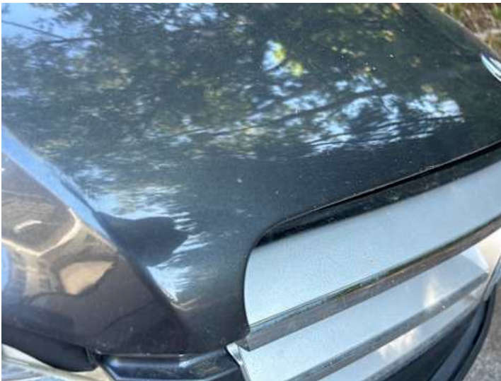
Motorhaube (Rost, Steinschlag)
