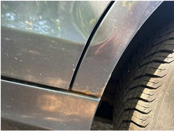
Seitenteil hinten links (Rost)
