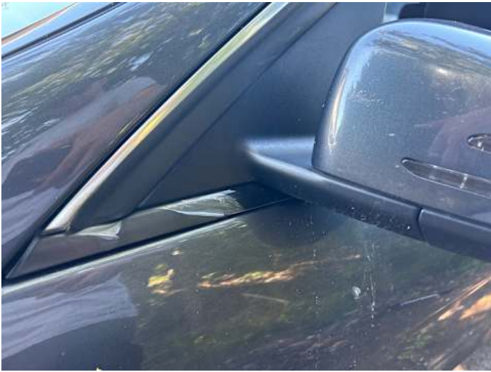
Fahrer ­ tür (Lackschaden)
