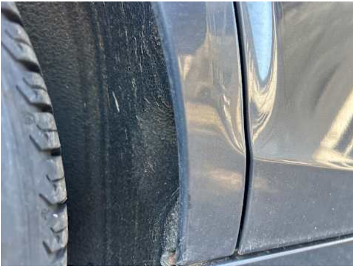
Seitenteil hinten rechts (Rost)
