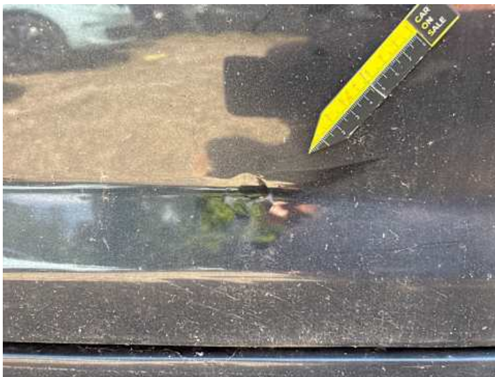
Beifahrertür (Rost, Lackschaden)
