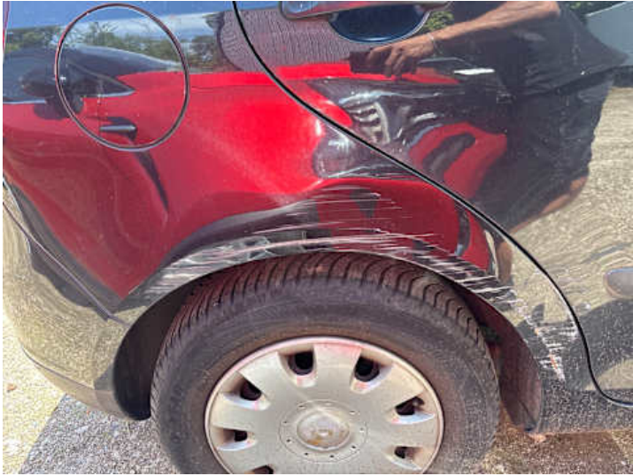
Seitenteil hinten rechts (Kratzer, Verformung, Rost)
