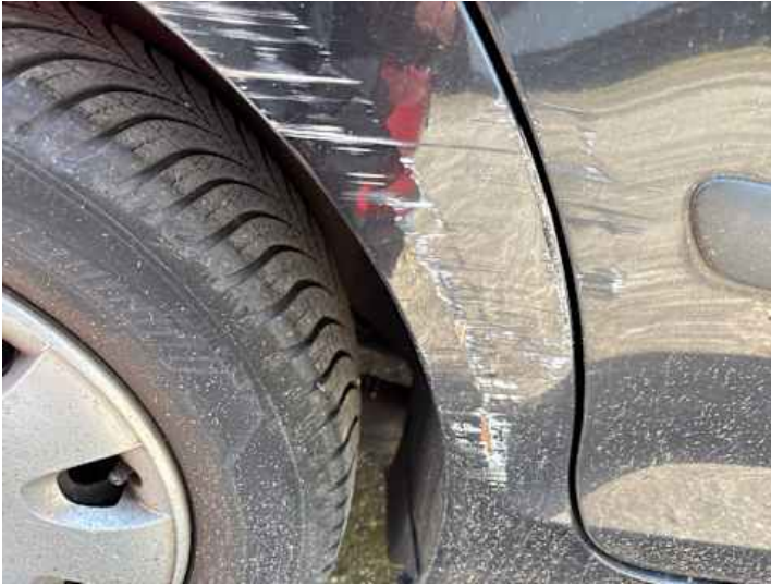
Seitenteil hinten rechts (Kratzer, Verformung, Rost)
