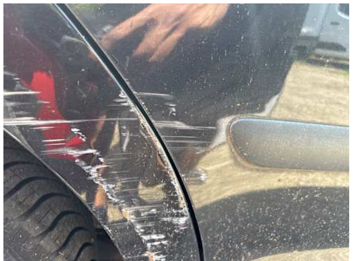
Türe hinten rechts (Kratzer, Lackschaden)
