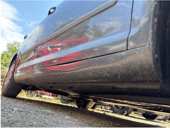
Schweller rechts (Verformung)
