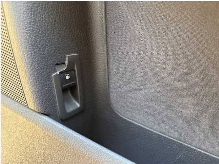
Innenraum (Verschleiß, Riss/Bruch)
