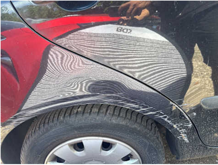
Seitenteil hinten rechts (Kratzer, Verformung, Rost)
