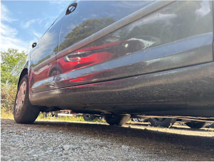
Schweller rechts (Verformung)
