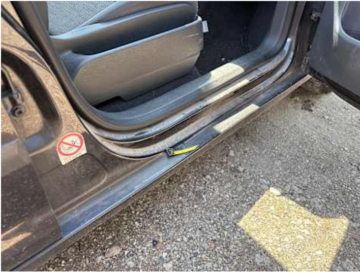
Schweller rechts (Verformung)
