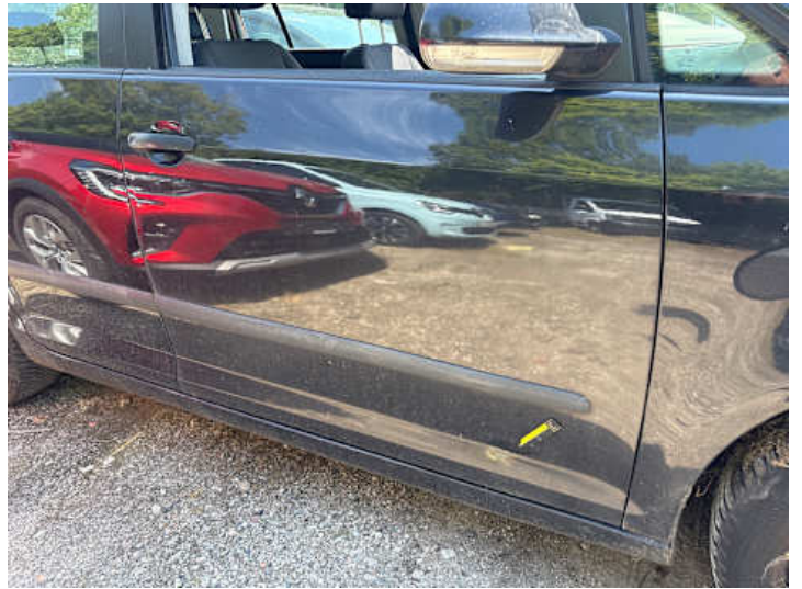
Beifahrertür (Rost, Lackschaden)
