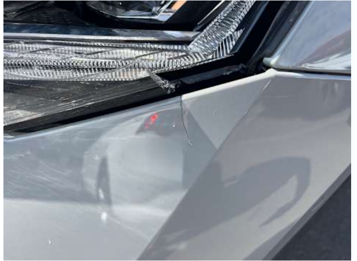
Stoßstange vorne (Riss/Bruch)
