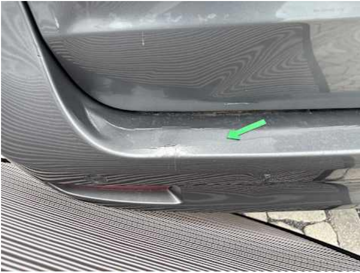
Stoßstange hinten (Verformung, Kratzer, Riss/Bruch)
