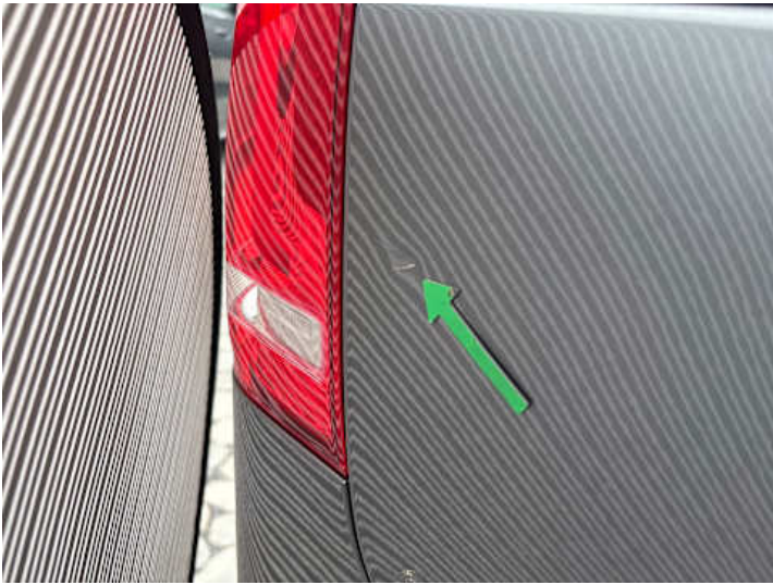
Seitenteil hinten rechts (Kratzer, Delle)
