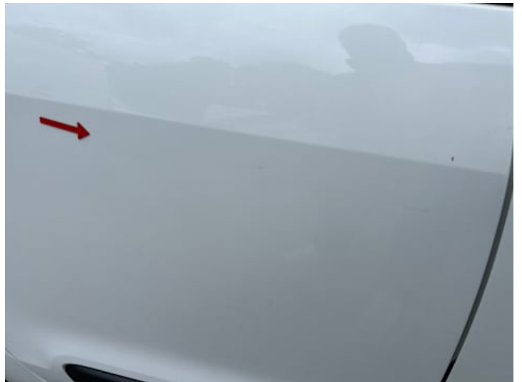
Türe hinten rechts (Kratzer)
