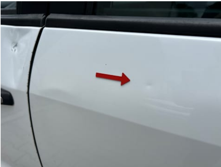
Türe hinten links (Kratzer, Delle)
