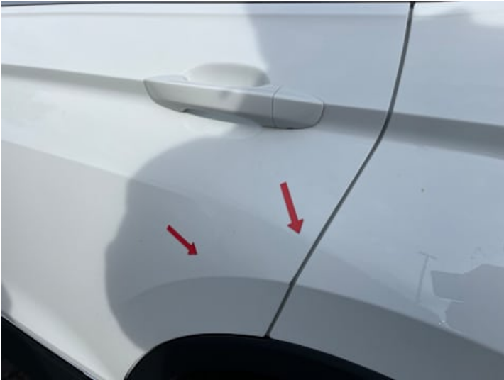
Türe hinten links (Delle, Kratzer)
