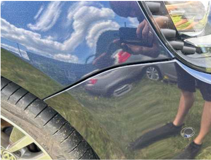
Stoßstange vorne (Spaltmaße ungenau)
