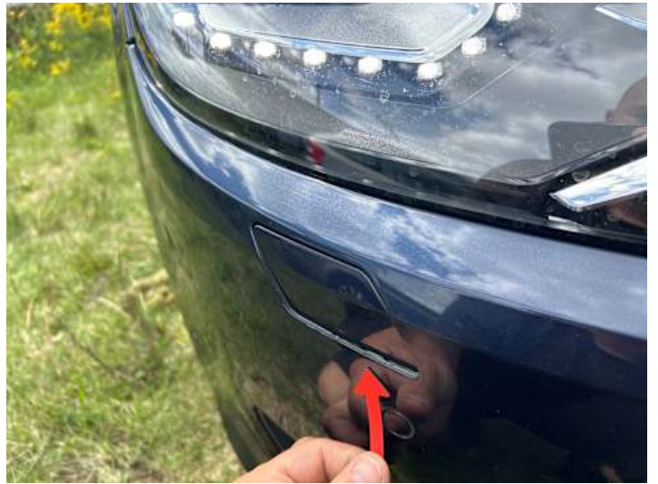
Stoßstange vorne (Spaltmaße ungenau)
