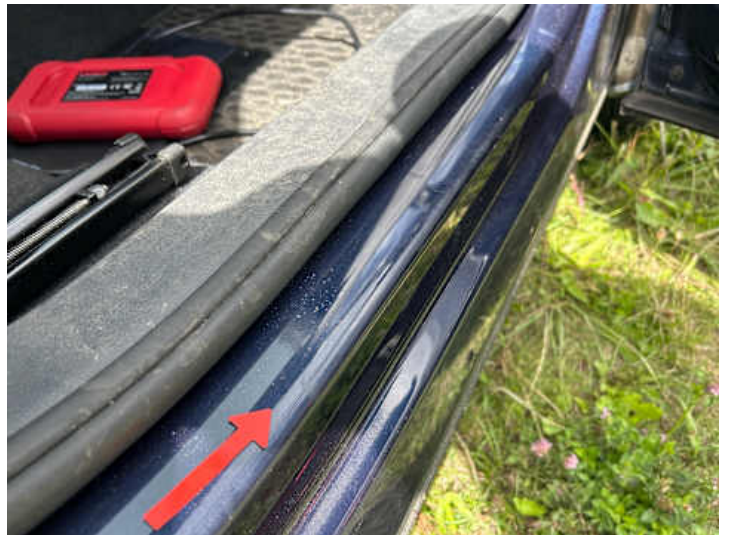
Schweller rechts (Kratzer)
