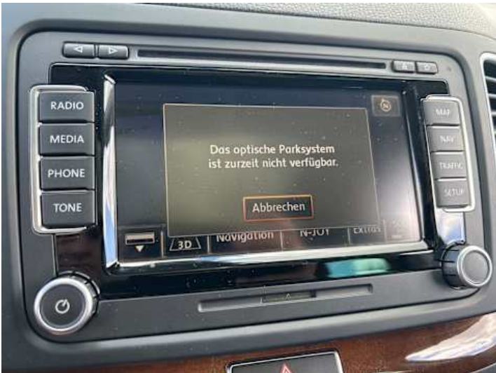
Innenraum (Anderer Schaden, Ohne Funktion): Rückfahrkamera ohne Funktion
