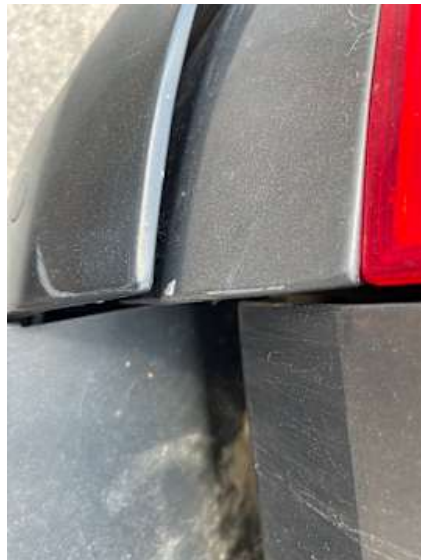
Seitenteil hinten links (Kratzer, Lackschaden, Delle)
