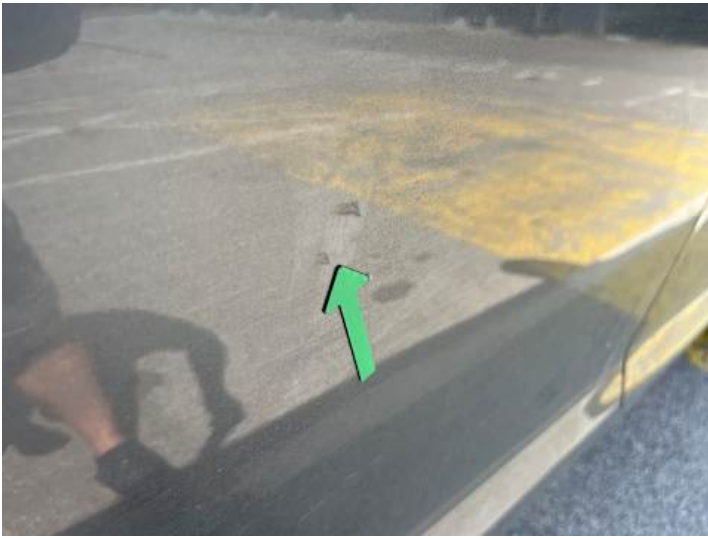
Türe hinten rechts (Delle, Kratzer)
