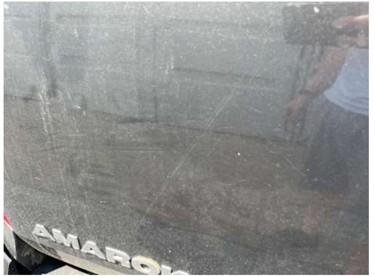
Heckklappe (Kratzer, Lackschaden)
