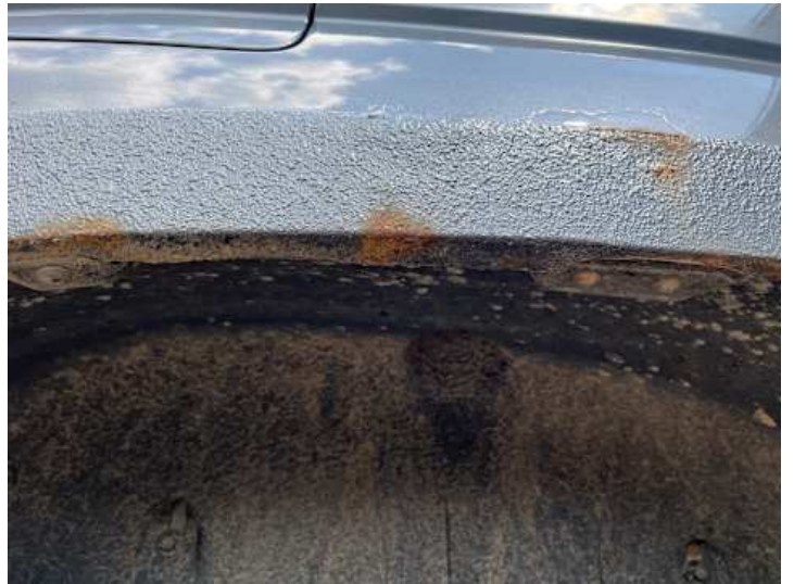
Seitenteil hinten links (Rost)
