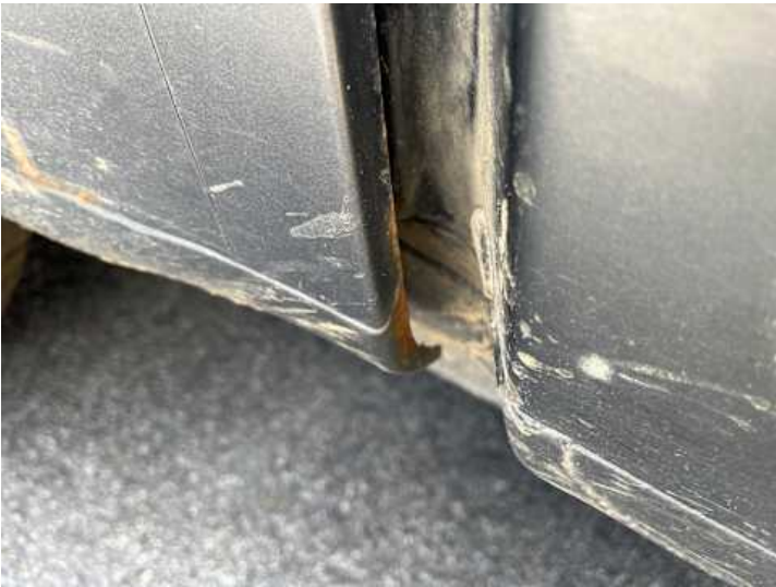
Seitenteil hinten rechts (Rost)
