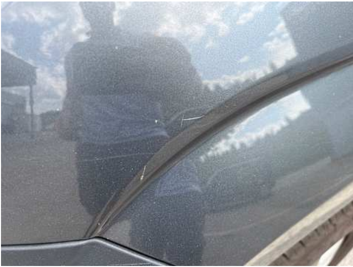
Kotflügel vorne links (Kratzer, Lackschaden)
