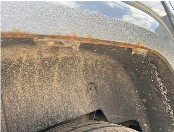
Seitenteil hinten rechts (Rost)
