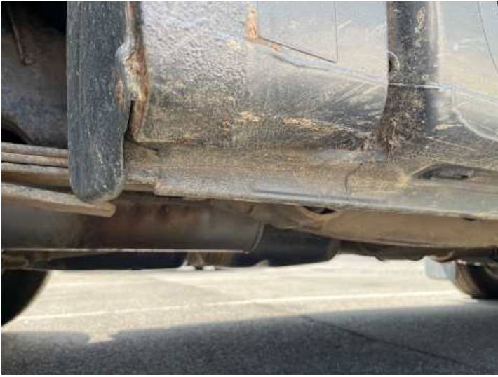
Seitenteil hinten rechts (Rost)
