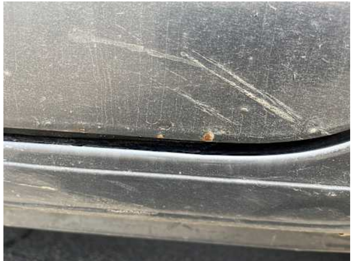
Türe hinten links (Rost)
