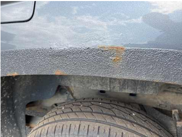
Seitenteil hinten links (Rost)
