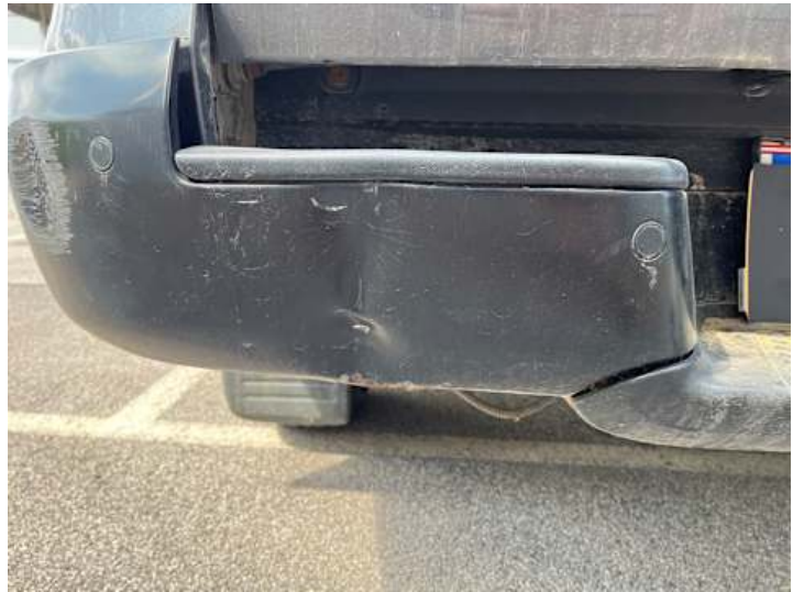
Stoßstange hinten (Verformung, Kratzer, Riss/Bruch)
