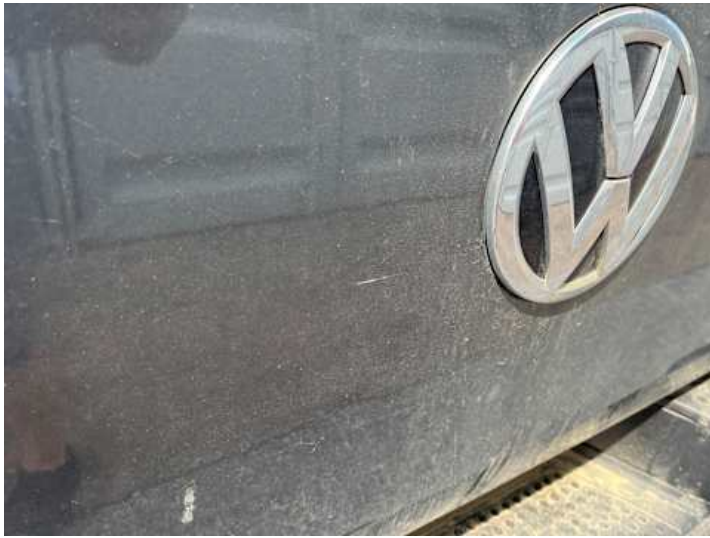
Heckklappe (Kratzer, Lackschaden)
