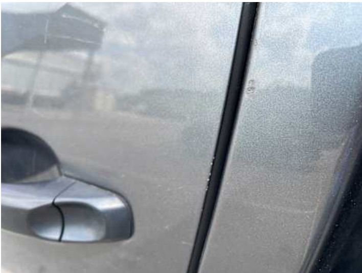
Türe hinten links (Lackschaden)
