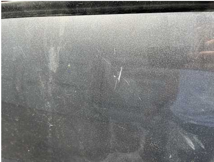
Heckklappe (Kratzer, Lackschaden)
