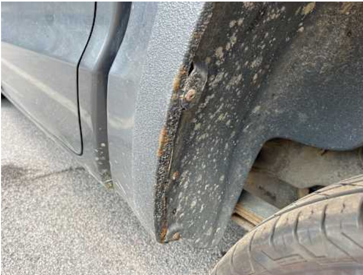
Seitenteil hinten links (Rost)
