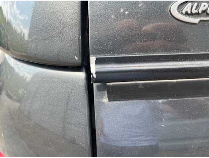
Heckklappe (Kratzer, Lackschaden)
