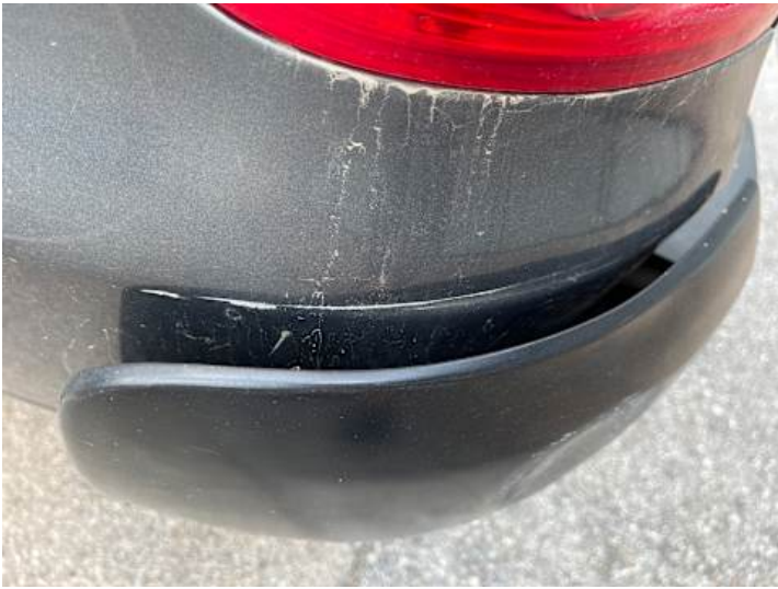
Seitenteil hinten links (Kratzer, Lackschaden, Delle)
