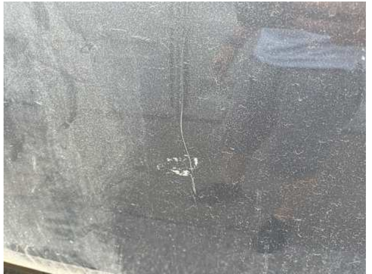
Heckklappe (Kratzer, Lackschaden)
