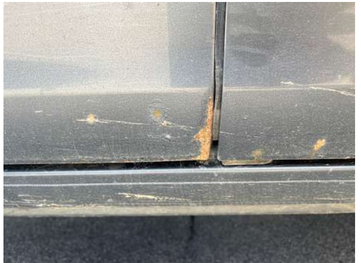
Türe hinten rechts (Rost)
