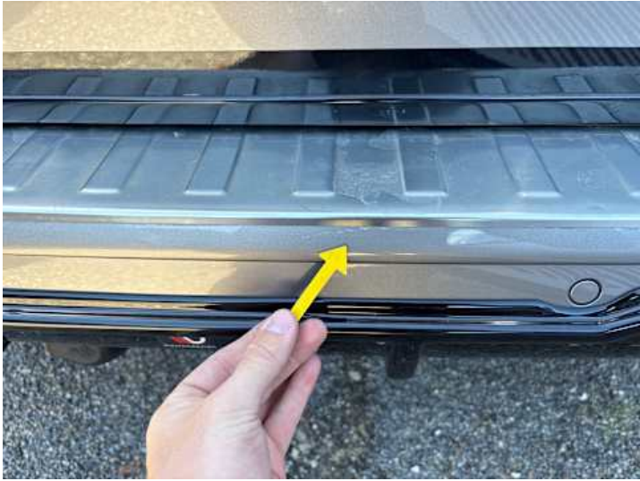
Stoßstange hinten (Kratzer, Lackschaden)
