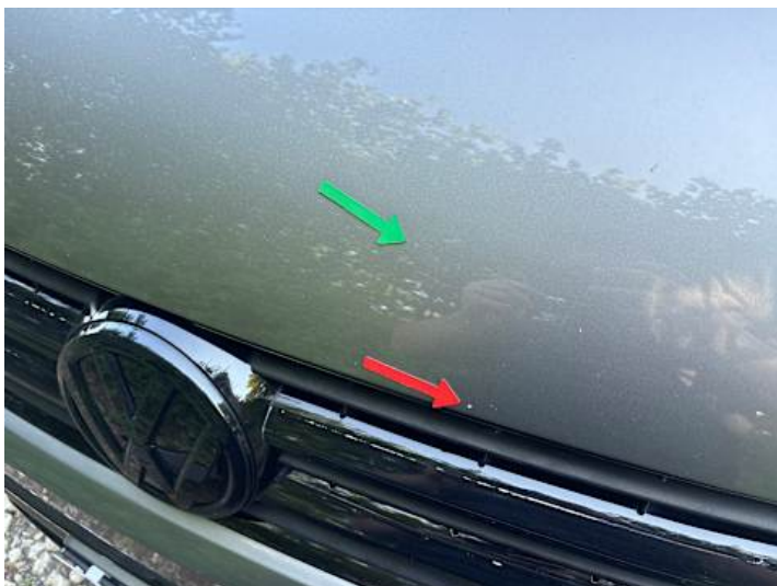
Motorhaube (Lackschaden, Steinschlag)
