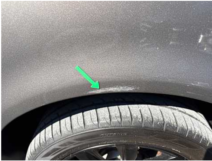
Seitenteil hinten links (Kratzer, Lackschaden)
