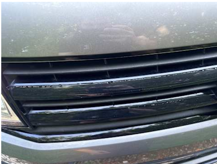
Stoßstange vorne (Anderer Schaden): Folie löst sich
