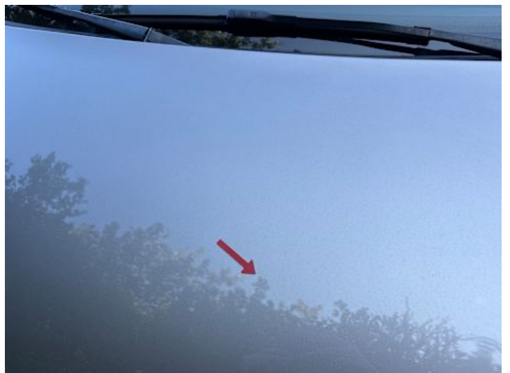
Motorhaube (Lackschaden, Steinschlag)
