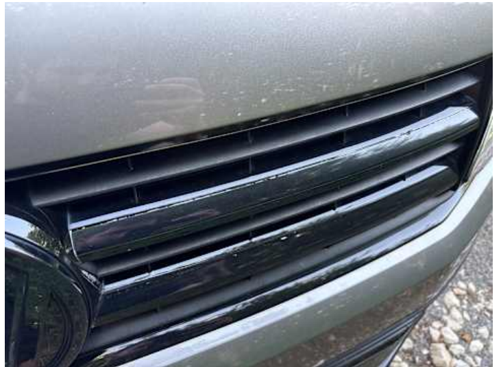
Stoßstange vorne (Anderer Schaden): Folie löst sich
