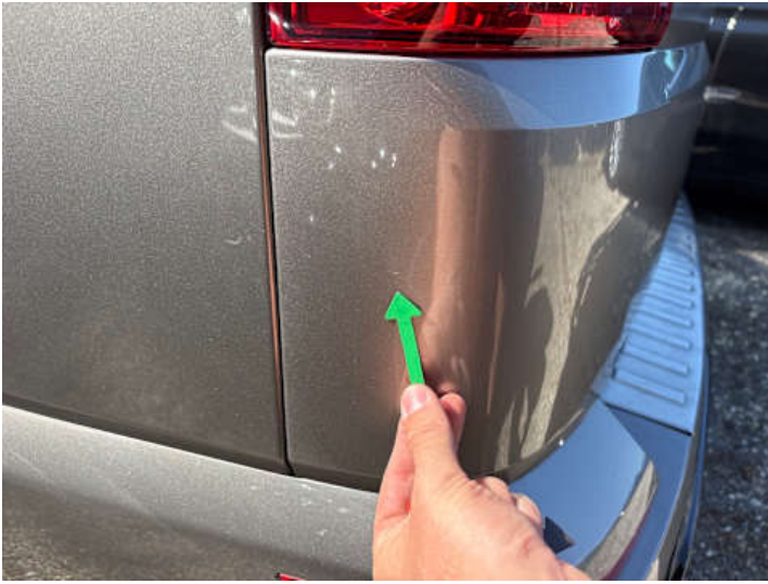
Stoßstange hinten (Kratzer, Lackschaden)
