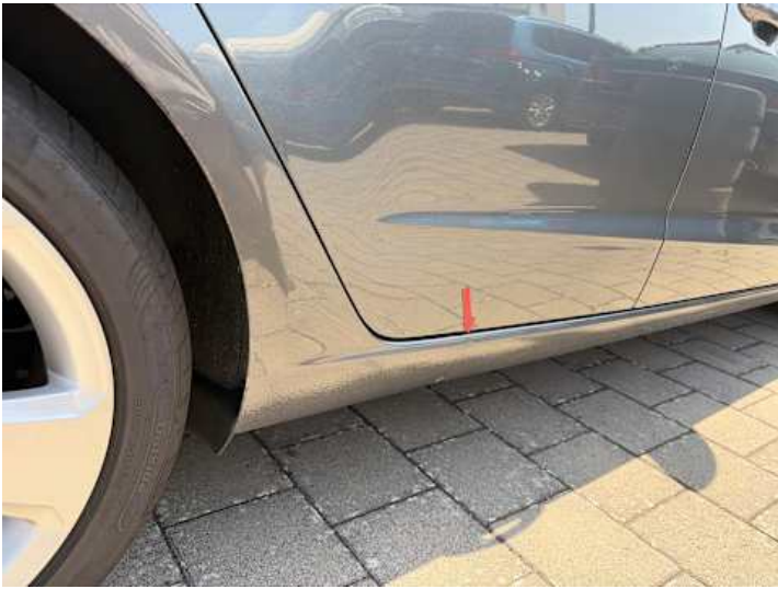
Schweller rechts (Rost, Kratzer)
