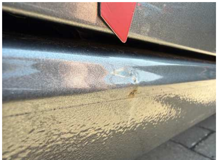
Schweller rechts (Rost, Kratzer)
