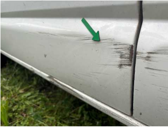
Türe hinten rechts (Kratzer, Lackschaden, Verformung, Rost)
