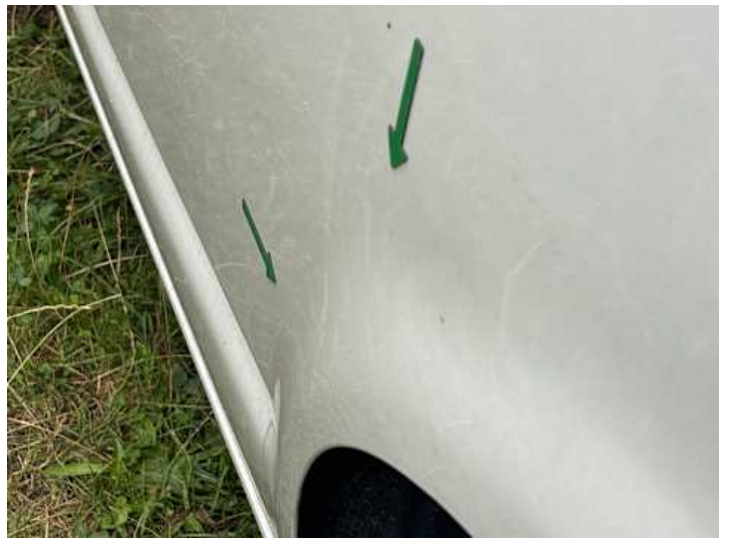
Seitenteil hinten links (Unsachgemäß instand gesetzt, Lackschaden)
