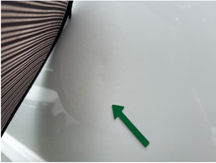
Seitenteil hinten links (Delle, Verformung)
