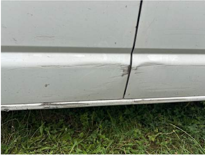
Türe hinten rechts (Kratzer, Lackschaden, Verformung, Rost)
