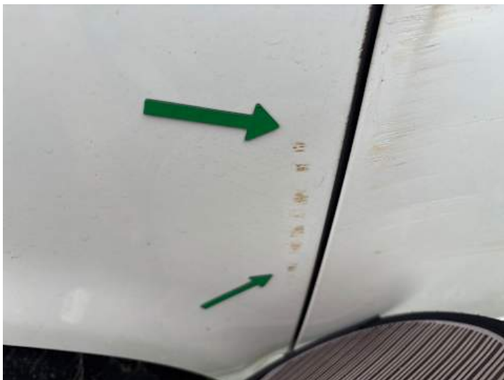
Seitenteil hinten rechts (Kratzer, Lackschaden, Verformung)
