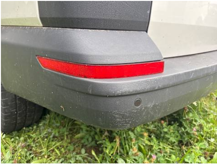
Stoßstange hinten (Kratzer, Verformung)
