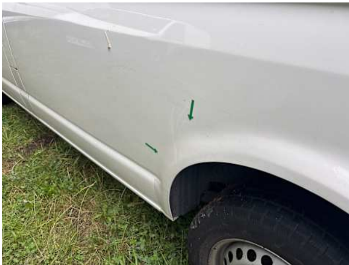
Seitenteil hinten links (Unsachgemäß instand gesetzt, Lackschaden)
