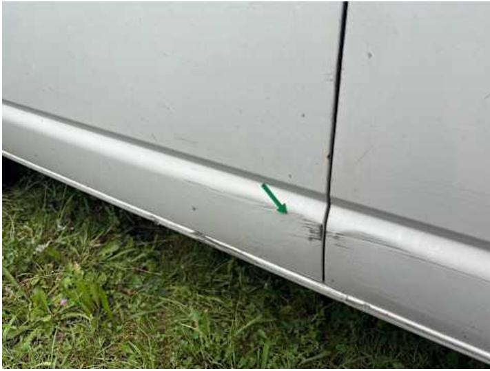
Türe hinten rechts (Kratzer, Lackschaden, Verformung, Rost)
