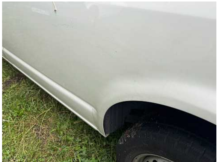
Seitenteil hinten links (Unsachgemäß instand gesetzt, Lackschaden)
