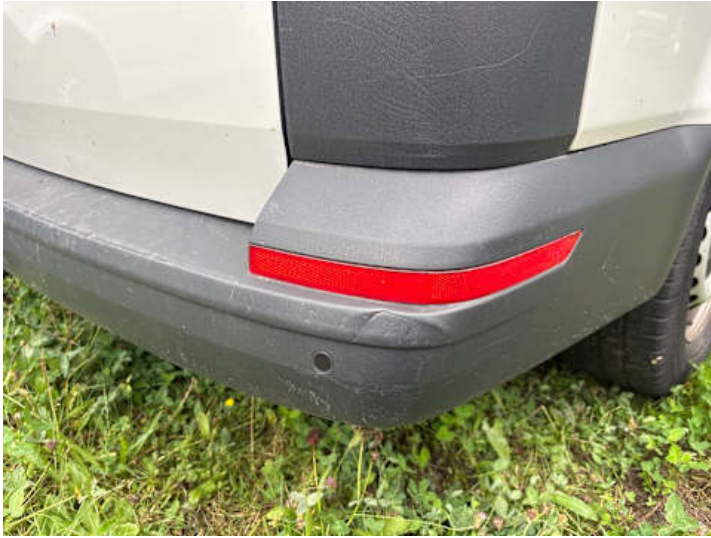
Stoßstange hinten (Kratzer, Verformung)
