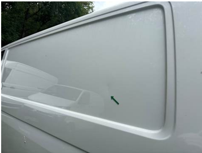
Seitenteil hinten links (Delle, Verformung)
