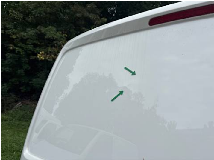
Heckklappe (Delle, Verformung)
