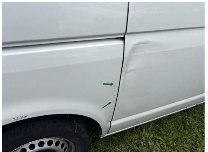
Seitenteil hinten rechts (Kratzer, Lackschaden, Verformung)
