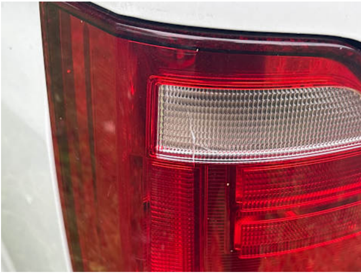
Rücklicht (links) (Kratzer, Riss/Bruch)
