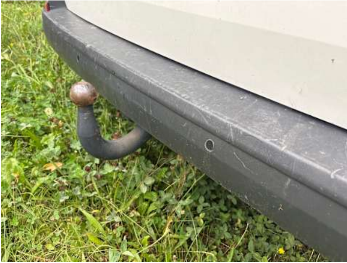
Stoßstange hinten (Kratzer, Verformung)
