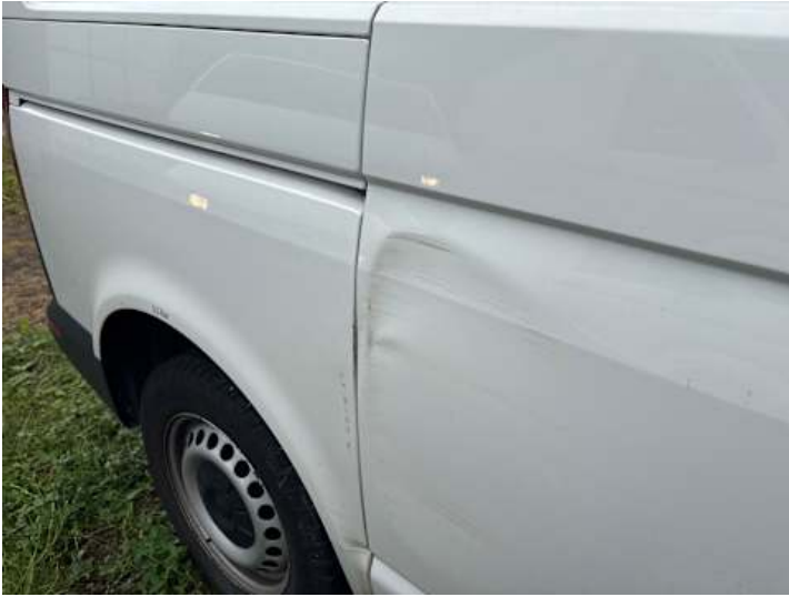
Türe hinten rechts (Kratzer, Lackschaden, Verformung, Rost)
