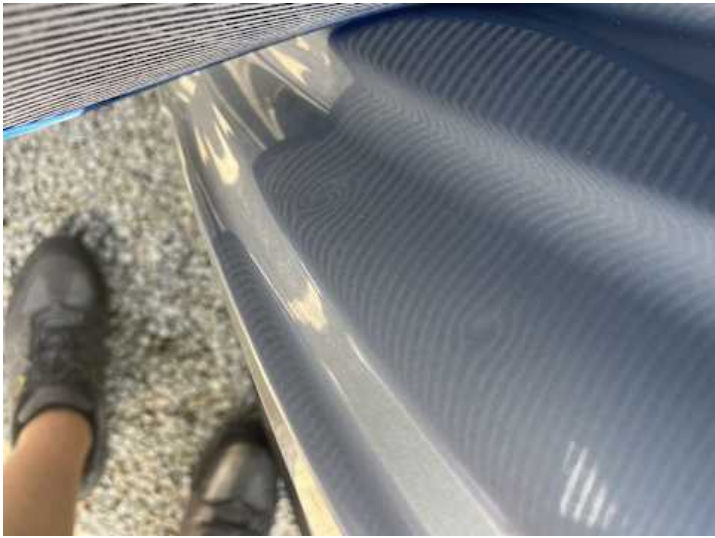
Seitenteil hinten links (Delle)
