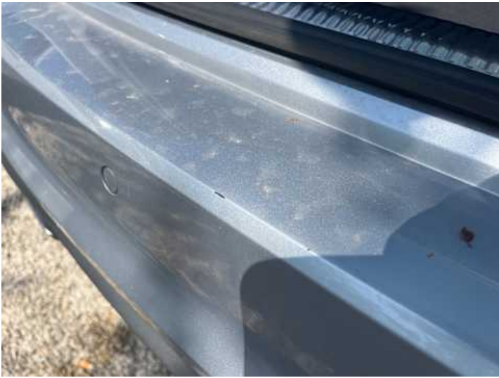
Stoßstange hinten (Lackschaden)
