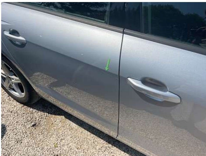
Türe hinten rechts (Lackschaden, Kratzer)
