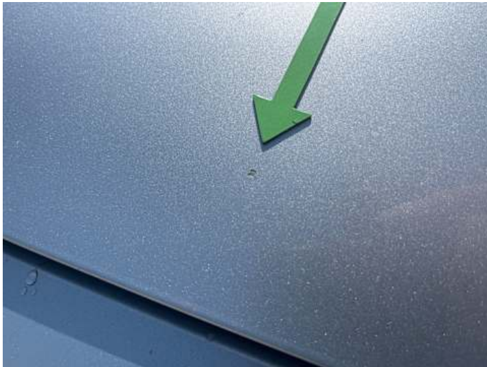
Motorhaube (Lackschaden, Steinschlag)
