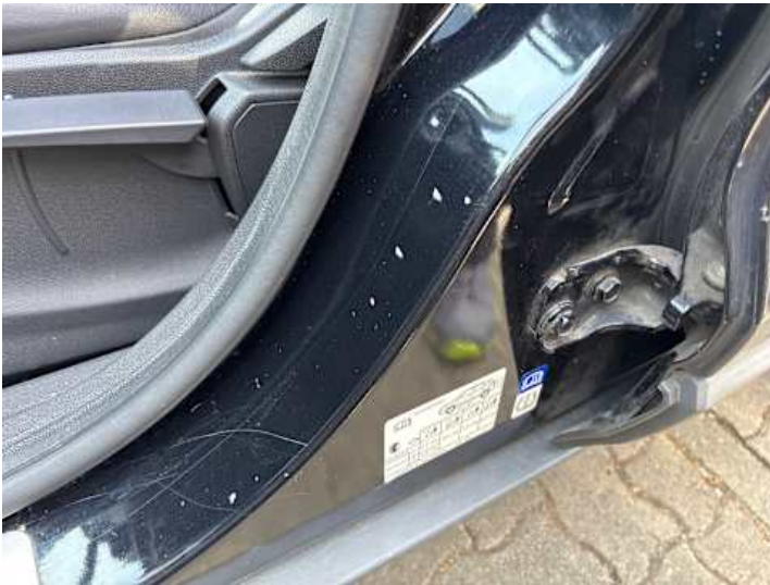
Schweller links (Lackschaden, Delle)
