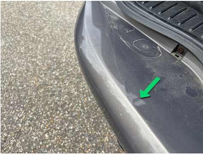
Stoßstange hinten (Riss/Bruch, Verformung)
