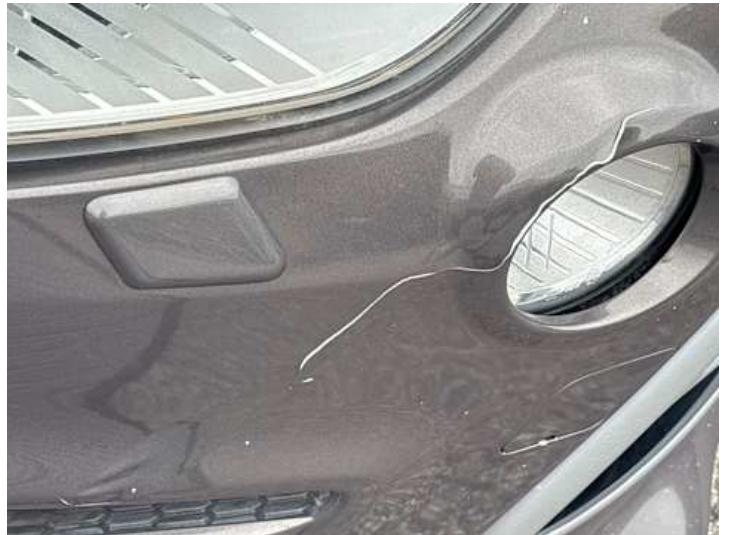
Stoßstange vorne (Riss/Bruch, Lackschaden, Verformung)
