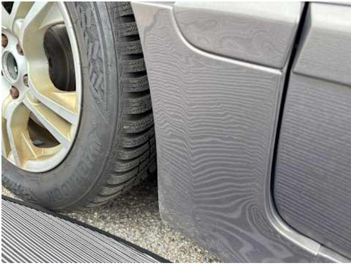
Schweller links (Verformung)
