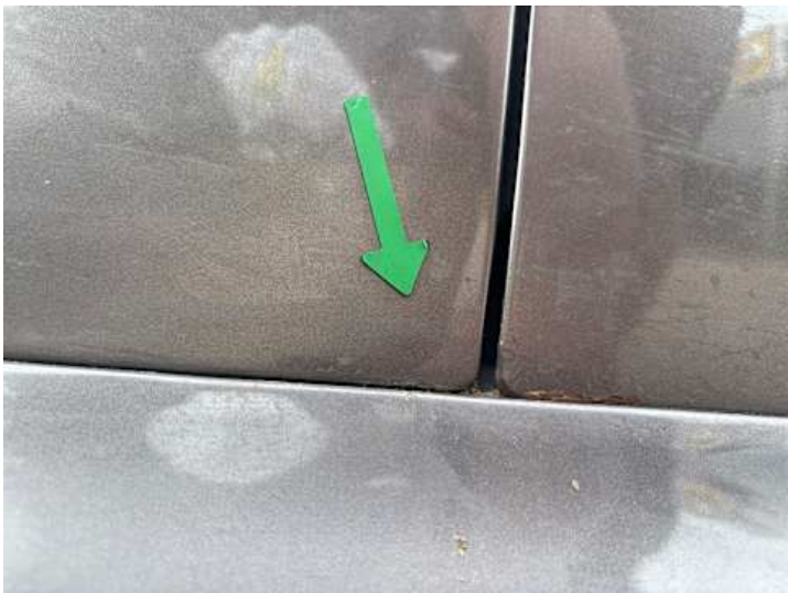
Türe hinten rechts (Rost)
