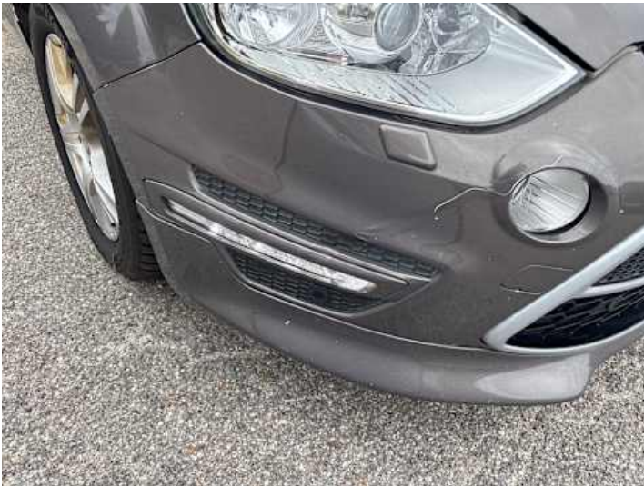
Stoßstange vorne (Riss/Bruch, Lackschaden, Verformung)
