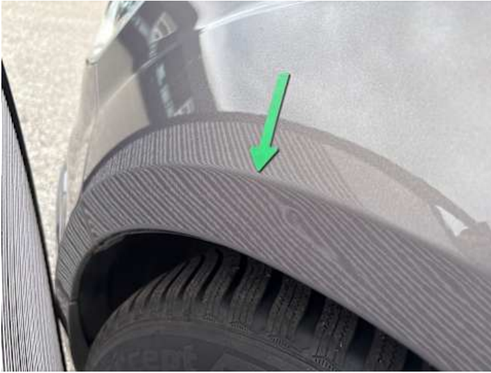
Kotflügel vorne links (Verformung)
