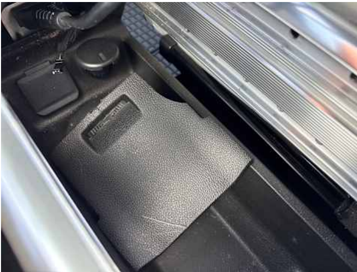
Innenraum (Anderer Schaden, Riss/Bruch): OBD Abdeckung beschädigt
