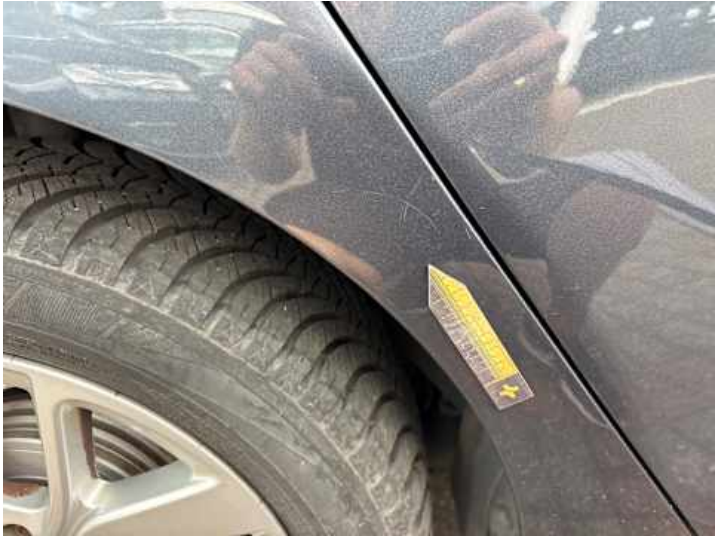
Seitenteil hinten rechts (Kratzer)
