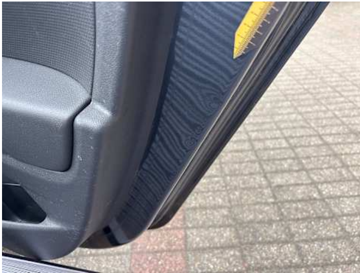
Türe hinten rechts (Delle)
