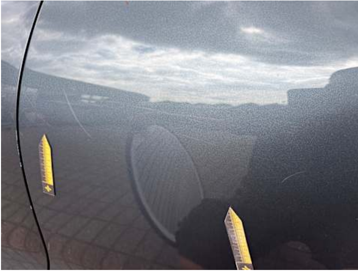
Türe hinten links (Kratzer)
