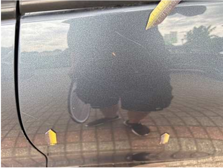
Türe hinten links (Kratzer)
