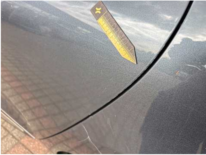
Türe hinten links (Kratzer)
