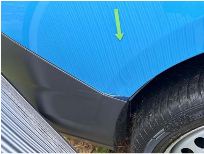
Seitenteil hinten rechts (Lackschaden, Rost, Delle)
