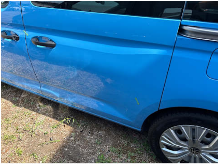
Türe hinten links (Delle)
