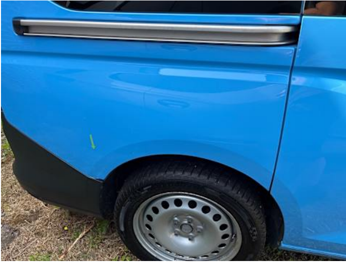
Seitenteil hinten rechts (Lackschaden, Rost, Delle)
