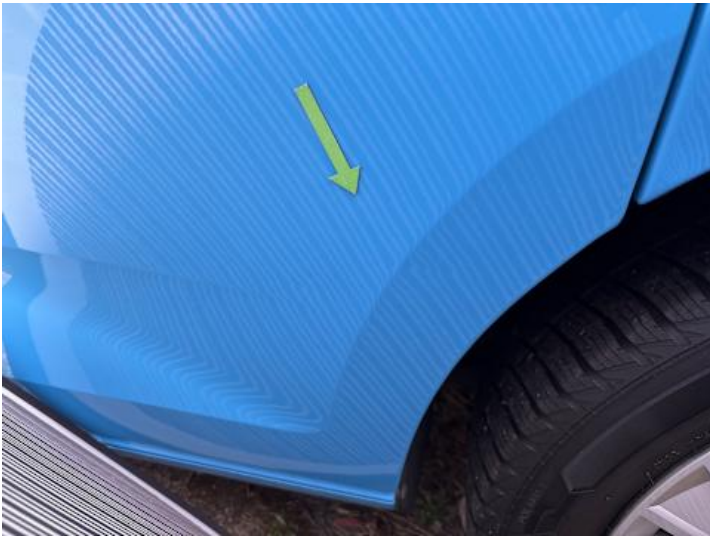
Türe hinten links (Delle)
