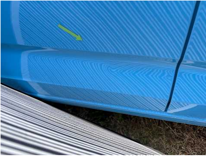
Türe hinten rechts (Delle)
