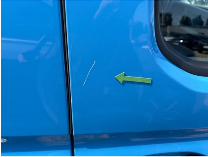
Beifahrtür (Kratzer, Lackschaden)
