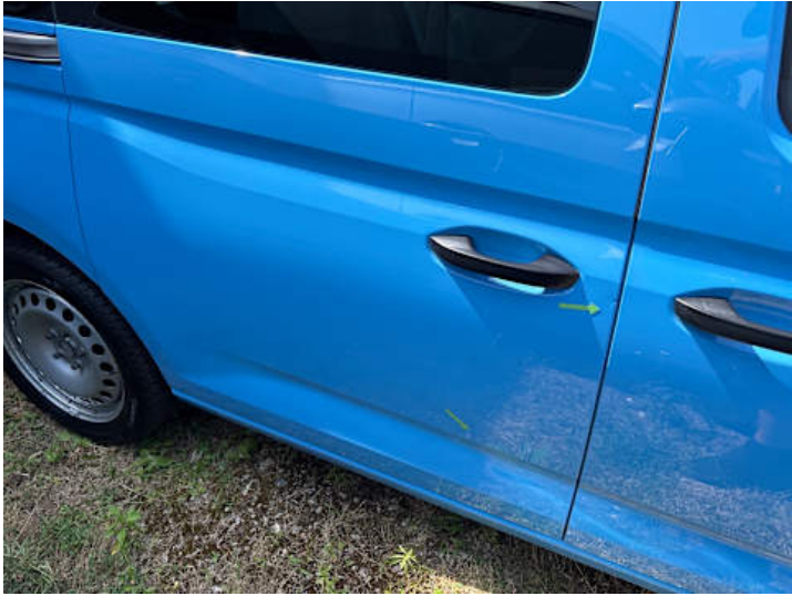
Türe hinten rechts (Lackschaden, Delle)
