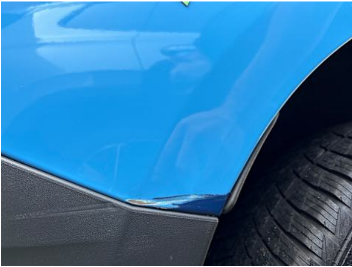
Seitenteil hinten rechts (Lackschaden, Rost, Delle)
