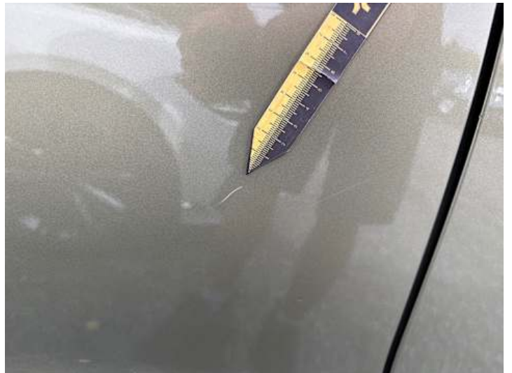
Türe hinten rechts (Kratzer, Delle)
