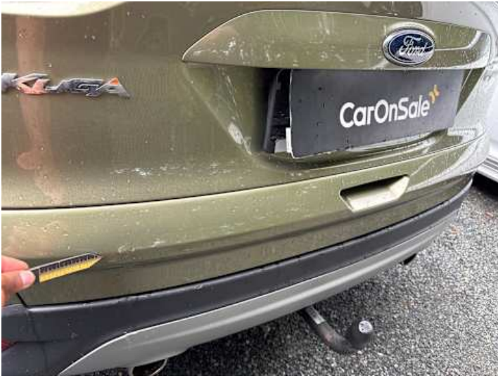
Heckklappe (Lackschaden, Unsachgemäß instand gesetzt)
