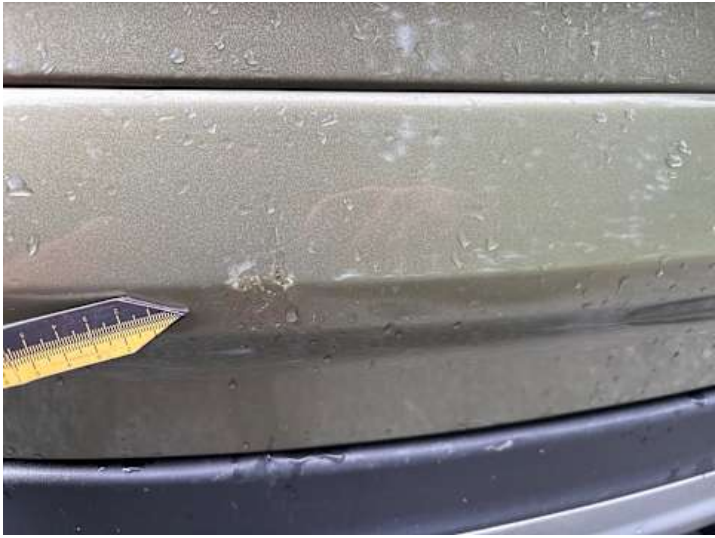
Heckklappe (Lackschaden, Unsachgemäß instand gesetzt)
