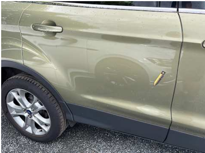
Türe hinten rechts (Kratzer, Delle)
