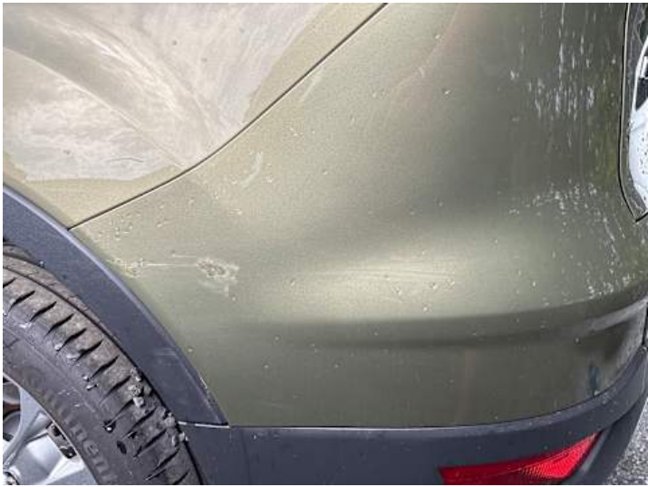
Stoßstange hinten (Lackschaden, Unsachgemäß instand gesetzt, Kratzer)
