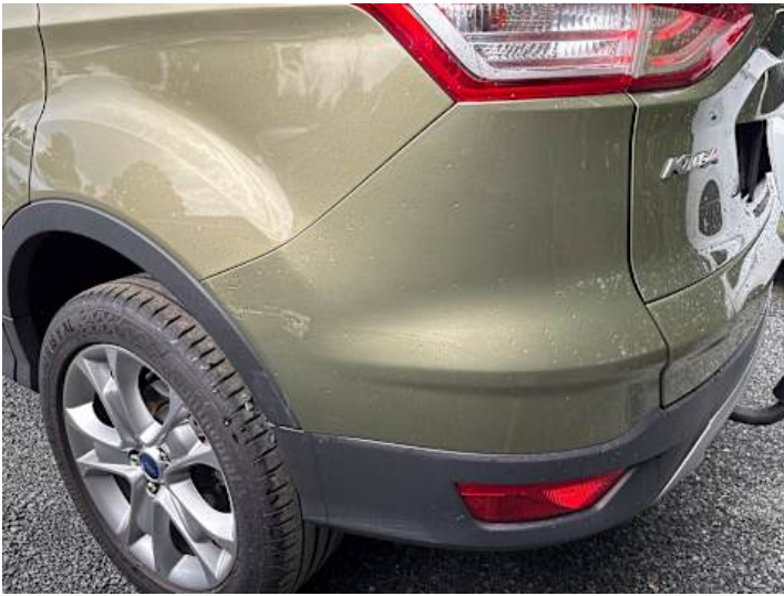
Stoßstange hinten (Lackschaden, Unsachgemäß instand gesetzt, Kratzer)
