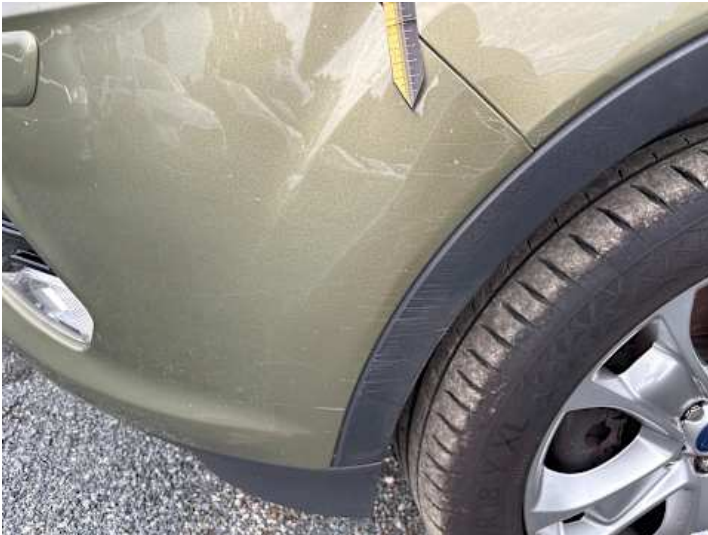
Stoßstange vorne (Kratzer, Lackschaden, Unsachgemäß instand gesetzt)
