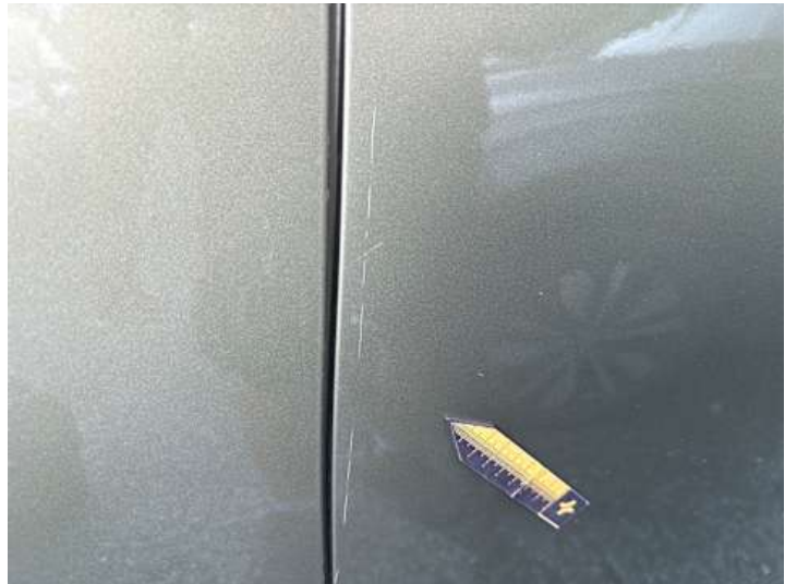
Türe hinten links (Kratzer)
