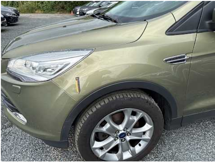
Kotflügel vorne links (Unsachgemäß instand gesetzt, Lackschaden)
