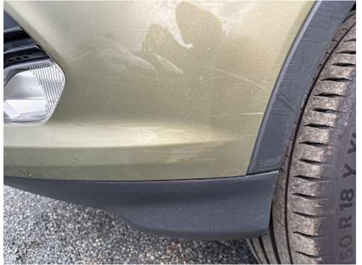
Stoßstange vorne (Kratzer, Lackschaden, Unsachgemäß instand gesetzt)
