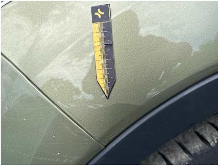
Kotflügel vorne links (Unsachgemäß instand gesetzt, Lackschaden)
