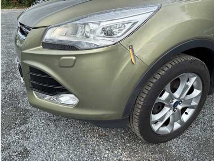
Stoßstange vorne (Kratzer, Lackschaden, Unsachgemäß instand gesetzt)
