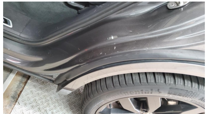
Dichtung Einstieg HL eingerissen ern.
