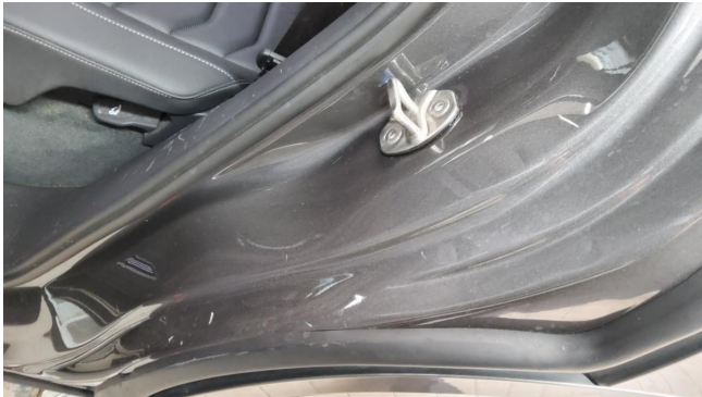
Einstieg HL Kratzer Dellen instandsetzen
