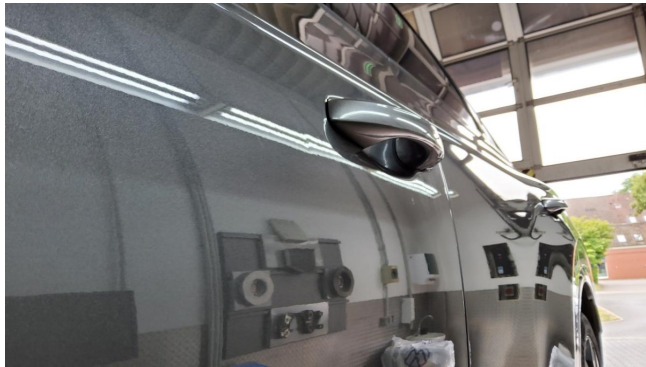
Tür vorne links - Delle entfernen
