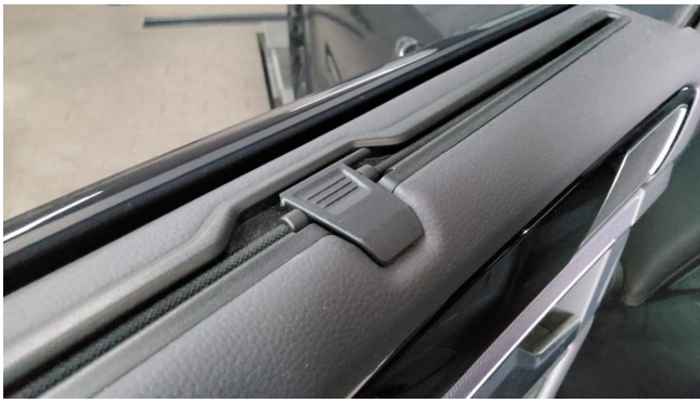
Sonnenschutz Rollo HL beschädigt ern.
