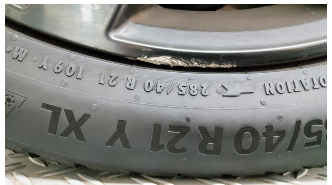
Alufelge VL am Felgenhorn beschädigt ern
