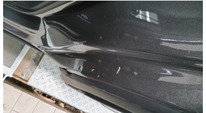
Einstieg HL Kratzer Dellen instandsetzen
