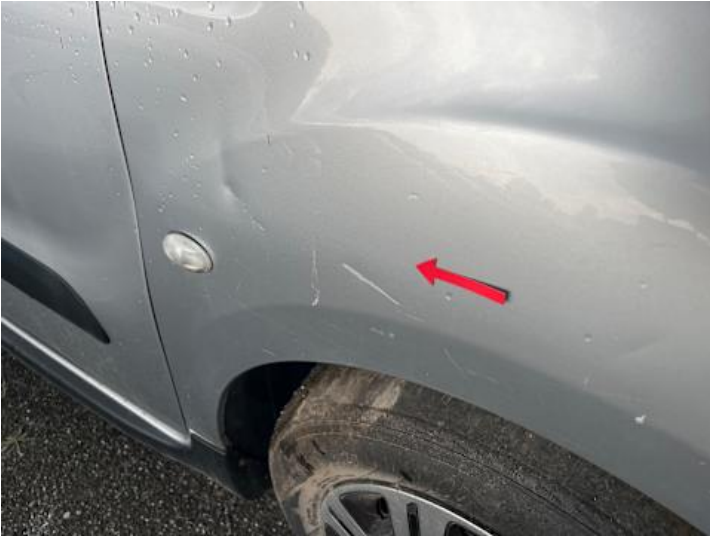
Kotflügel vorne rechts (Delle, Lackschaden, Verformung)
