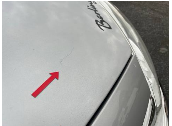
Motorhaube (Rost, Lackschaden)
