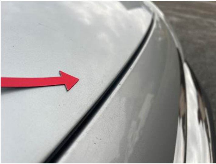
Motorhaube (Rost, Lackschaden)
