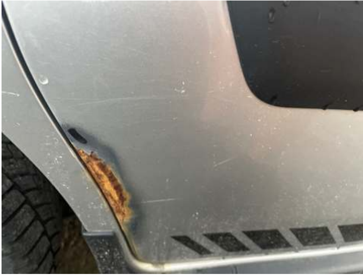
Türe hinten rechts (Rost)
