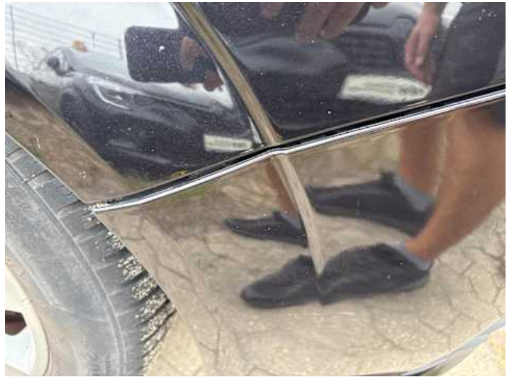
Stoßstange vorne (Spaltmaße ungenau)
