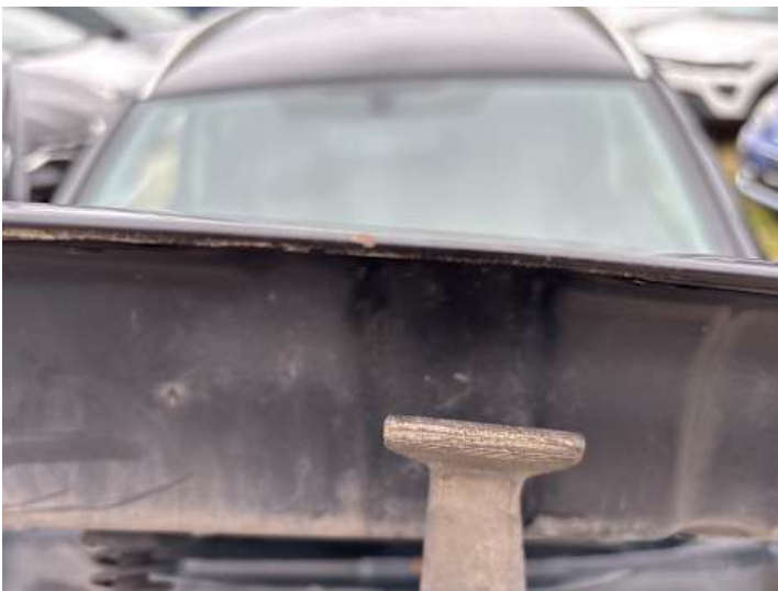
Motorhaube (Lackschaden, Rost)
