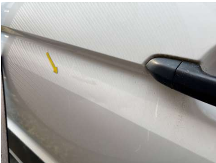
Türe hinten rechts (Delle)
