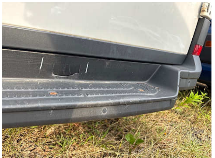
Stoßstange hinten (Riss/Bruch)
