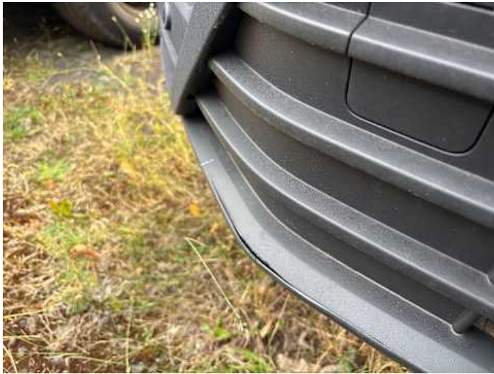
Stoßstange vorne (Riss/Bruch)
