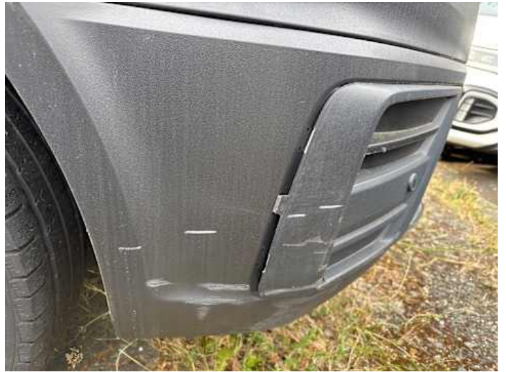
Stoßstange vorne (Riss/Bruch)
