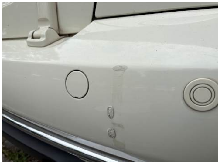
Stoßstange hinten (Kratzer, Verformung)
