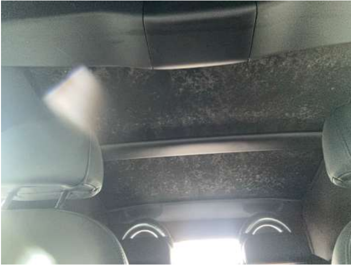
Innenraum (Verschmutzung, Anderer Schaden): Schimmel
