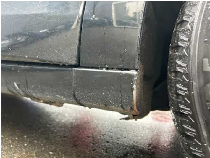
Schweller rechts (Rost, Lackschaden, Verformung)
