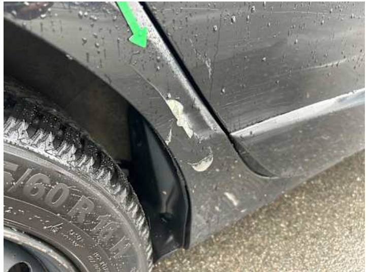
Schweller rechts (Rost, Lackschaden, Verformung)
