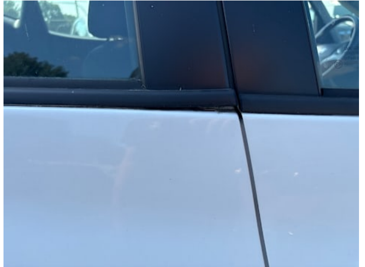
Türe hinten rechts (Spaltmaße ungenau)
