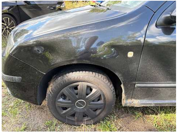
Kotflügel vorne links (Rost, Kratzer)
