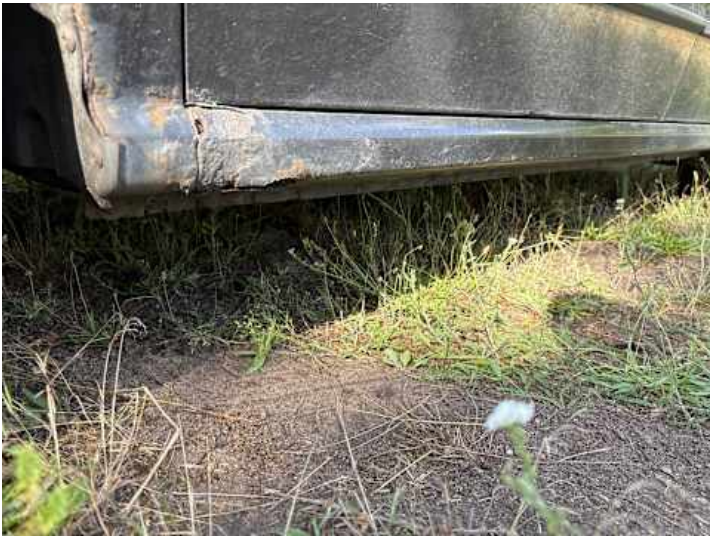
Schweller links (Rost)
