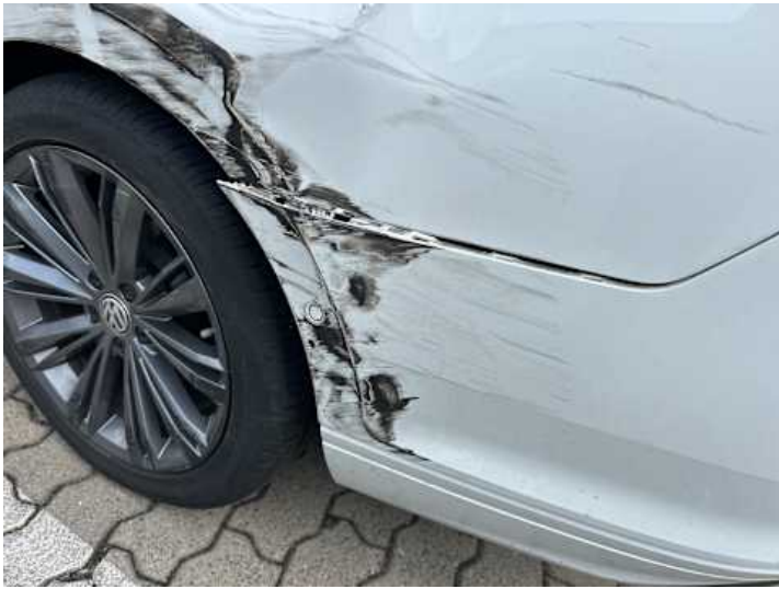
Stoßstange hinten (Kratzer, Verformung)
