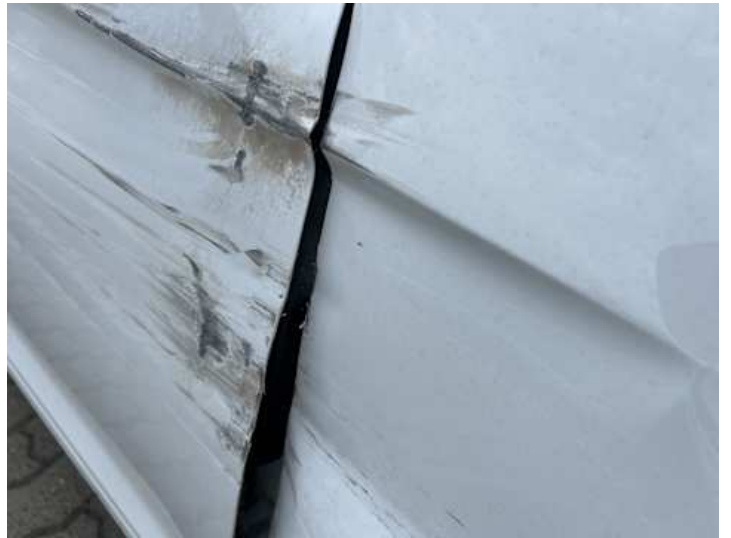
Beifahrtür (Verformung, Kratzer)
