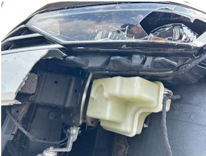
Stoßstange vorne (Riss/Bruch, Verformung)
