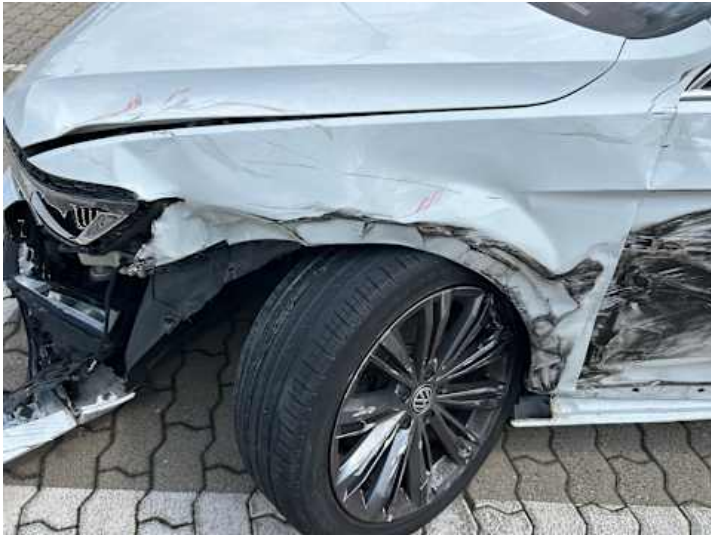
Kotflügel vorne links (Verformung, Riss/Bruch)
