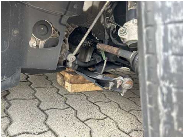
Rad (Anderer Schaden, Verformung, Riss/Bruch): Unfallschaden
