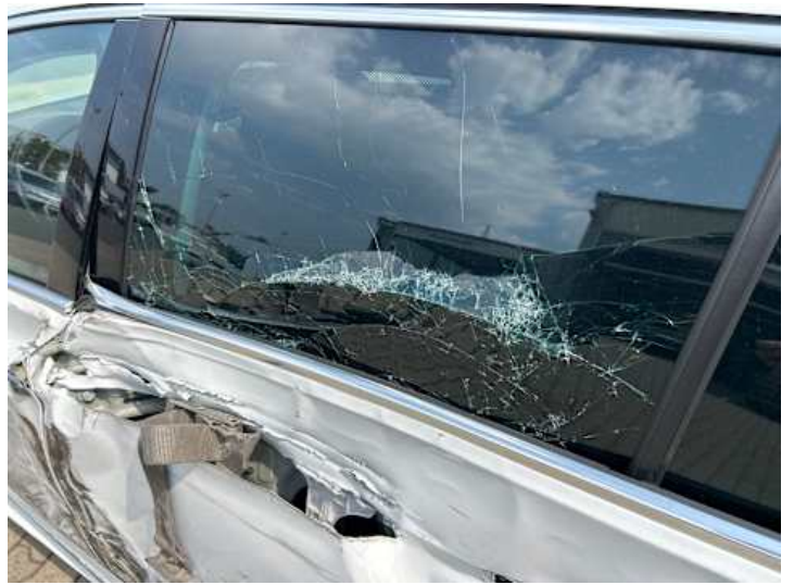
Türe hinten links (Kratzer, Verformung, Riss/Bruch)
