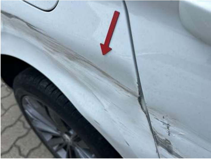
Seitenteil hinten rechts (Kratzer, Verformung)
