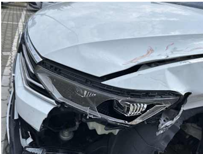
Scheinwerfer (links) (Riss/Bruch)
