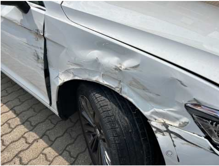
Kotflügel vorne rechts (Verformung)
