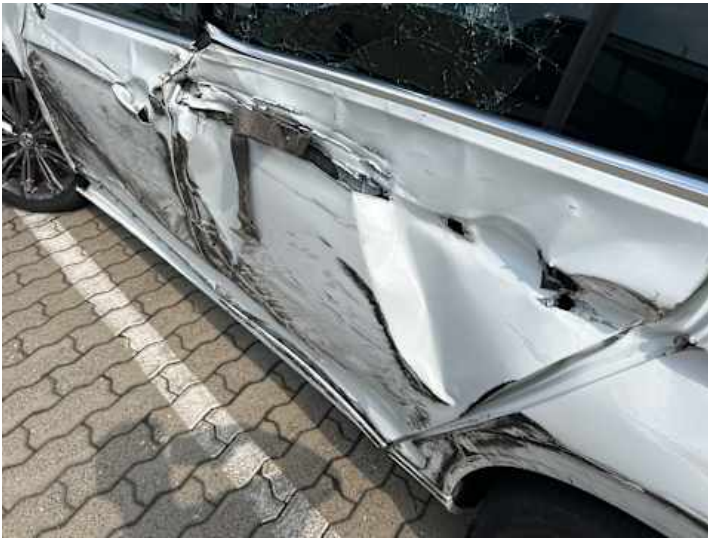
Türe hinten links (Kratzer, Verformung, Riss/Bruch)
