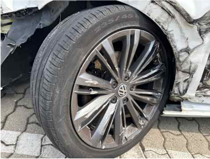
Rad (Anderer Schaden, Verformung, Riss/Bruch): Unfallschaden
