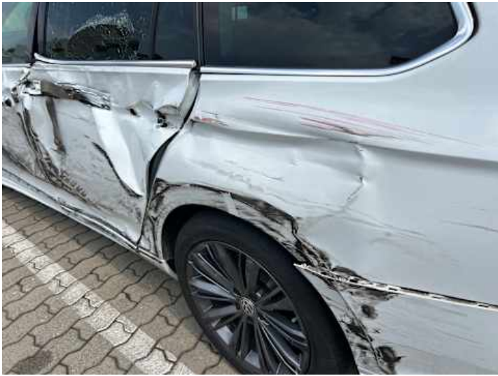
Seitenteil hinten links (Verformung, Kratzer)
