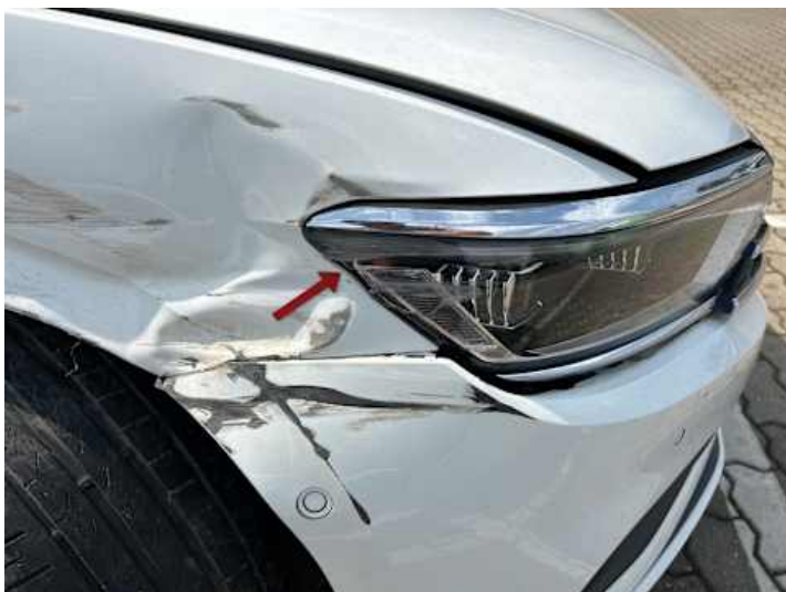
Scheinwerfer (rechts) (Riss/Bruch)
