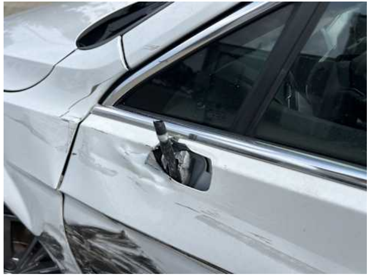
Fahrtür (Kratzer, Verformung, Riss/Bruch)
