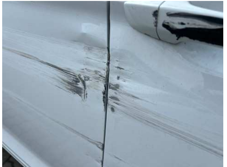
Türe hinten rechts (Verformung, Kratzer)
