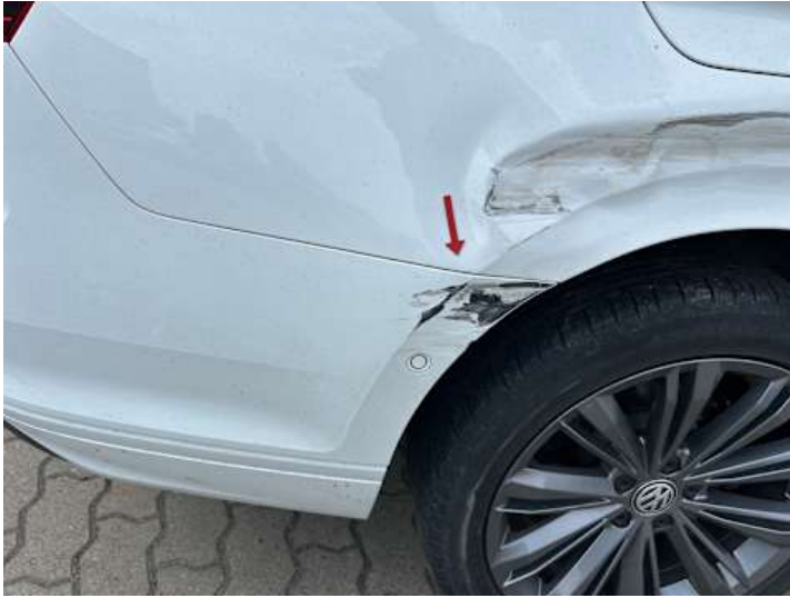
Stoßstange hinten (Kratzer, Verformung)
