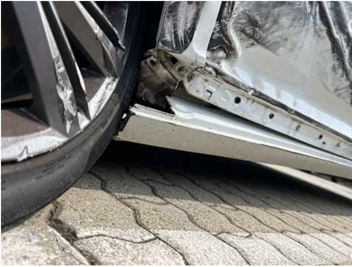
Schweller links (Riss/Bruch)
