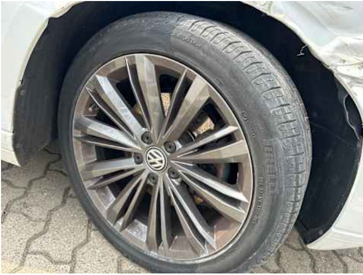
Rad (Anderer Schaden, Verformung, Riss/Bruch): Unfallschaden
