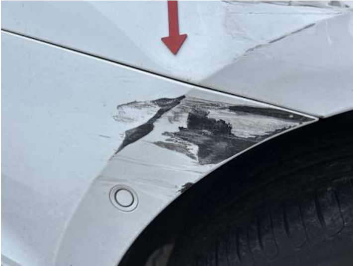
Stoßstange hinten (Kratzer, Verformung)
