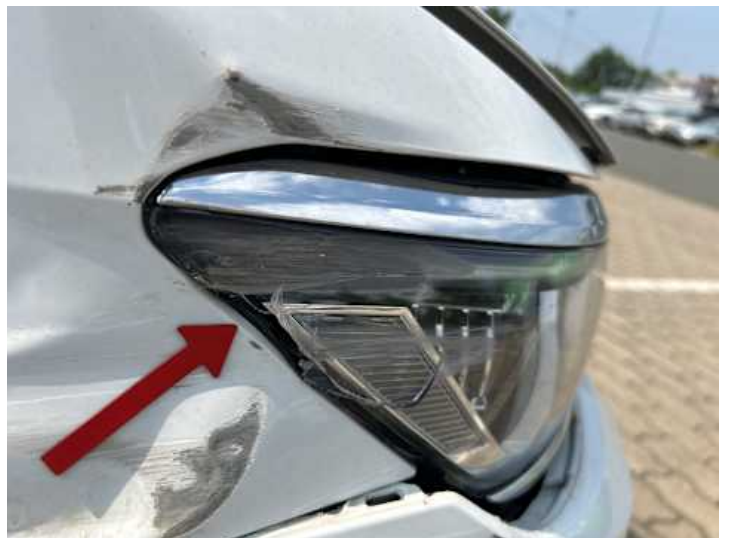
Scheinwerfer (rechts) (Riss/Bruch)
