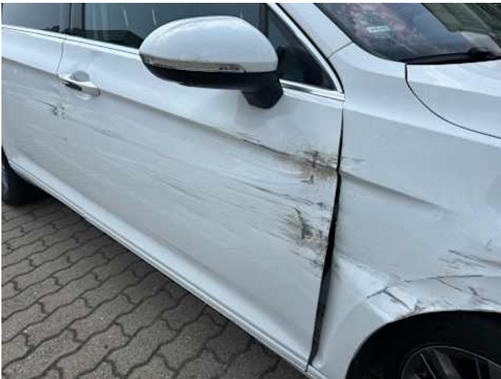
Beifahrtür (Verformung, Kratzer)
