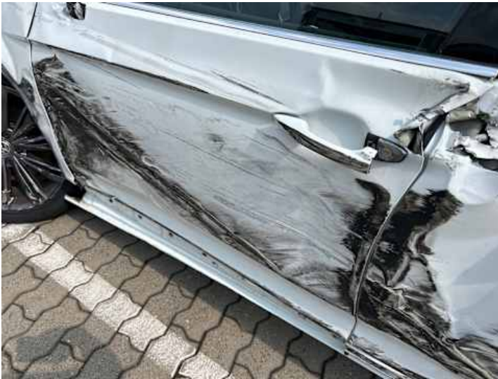
Fahrtür (Kratzer, Verformung, Riss/Bruch)
