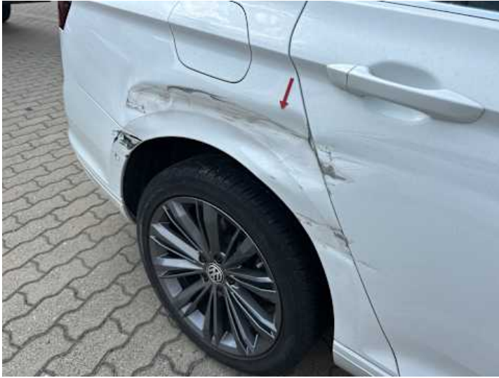
Seitenteil hinten rechts (Kratzer, Verformung)
