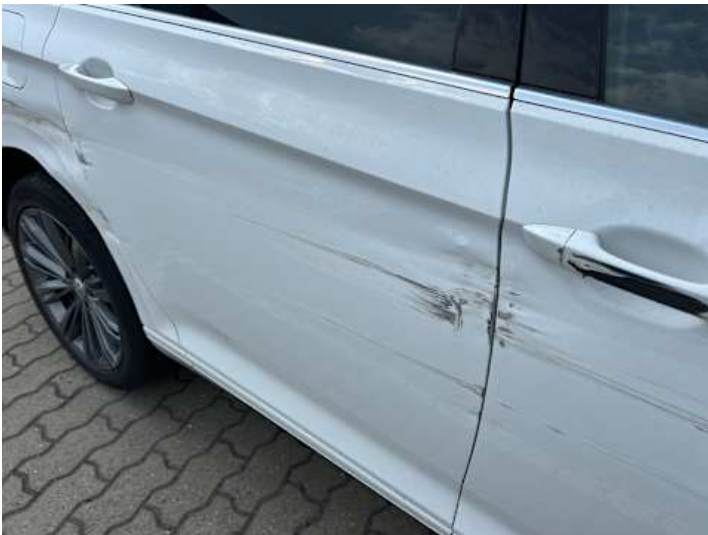
Türe hinten rechts (Verformung, Kratzer)
