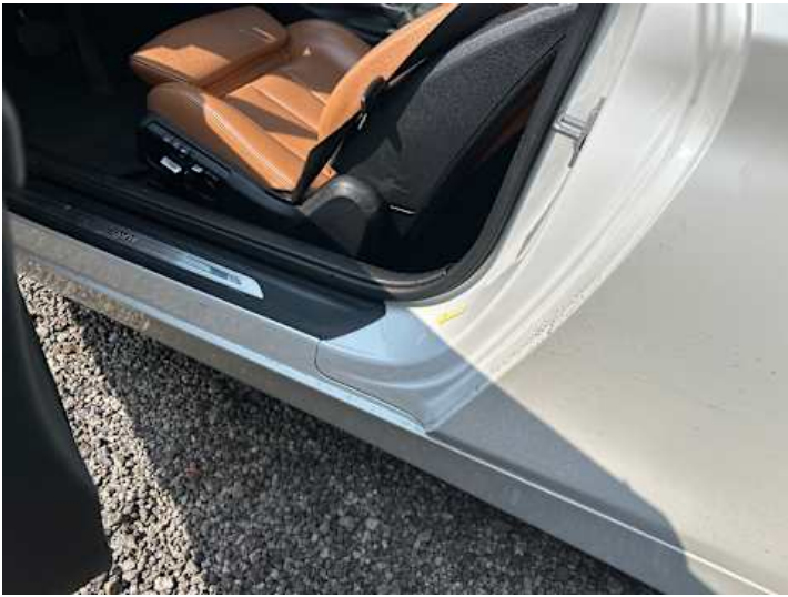
Schweller links (Lackschaden)
