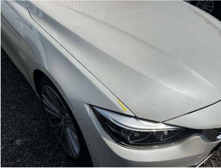
Kotflügel vorne rechts (Lackschaden, Steinschlag)
