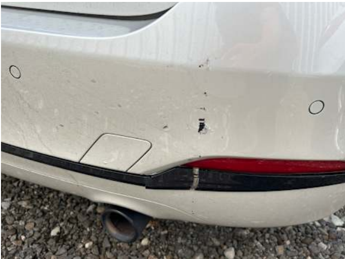
Stoßstange hinten (Lackschaden, Riss/Bruch)
