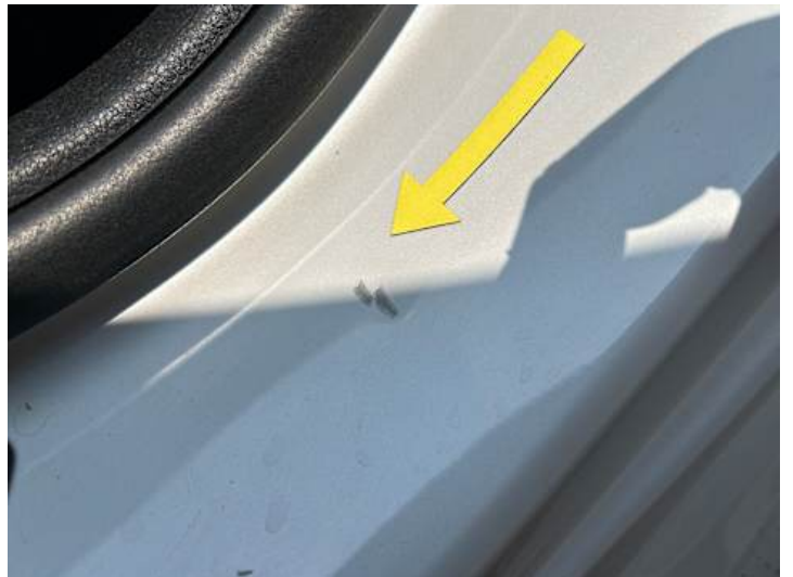
Schweller links (Lackschaden)
