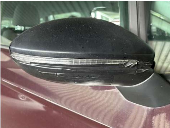
Beifahrertür (Riss/Bruch, Unsachgemäß instand gesetzt)
