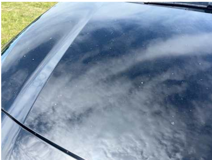
Motorhaube (Lackschaden, Steinschlag)
