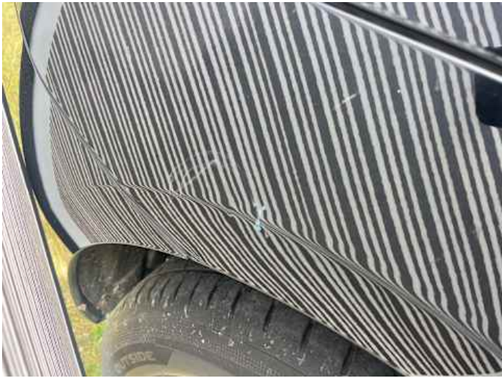
Seitenteil hinten rechts (Delle)
