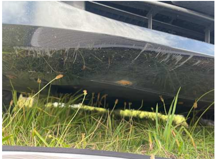
Stoßstange vorne (Kratzer, Lackschaden)
