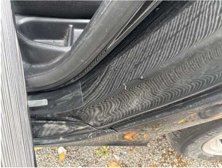
Schweller links (Delle, Kratzer)
