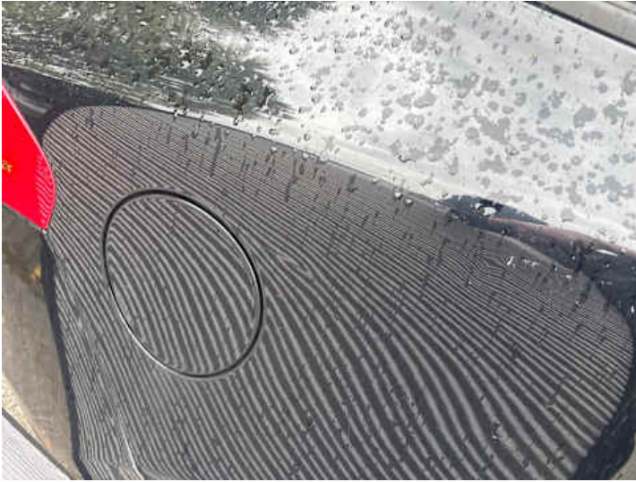
Seitenteil hinten rechts (Verformung)
