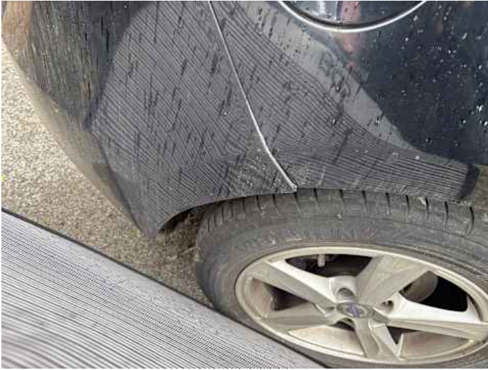
Stoßstange hinten (Verformung, Spaltmaße ungenau)
