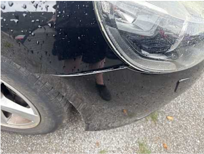
Stoßstange vorne (Spaltmaße ungenau)
