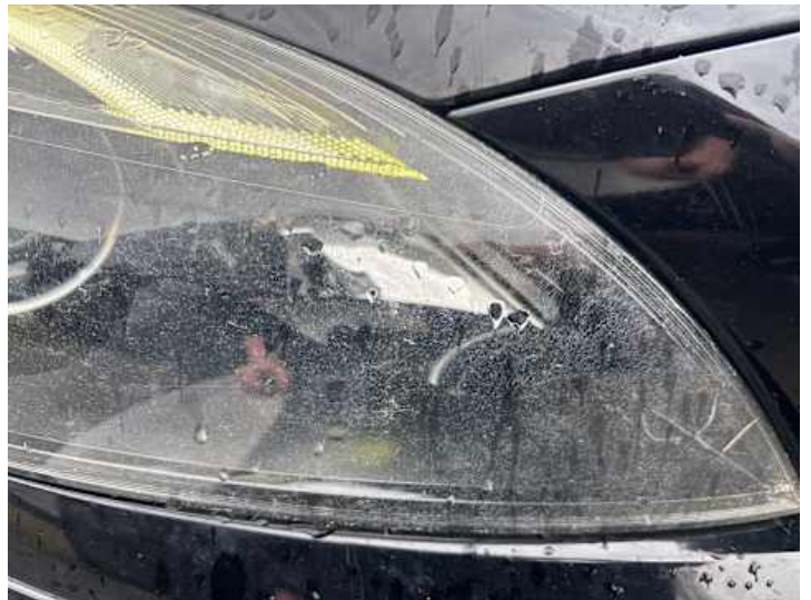
Scheinwerfer (rechts) (Anderer Schaden): Rissig
