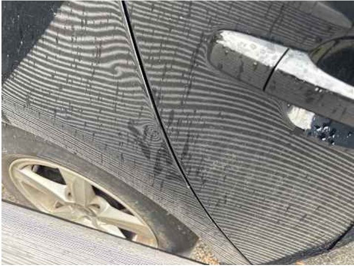
Seitenteil hinten rechts (Verformung)
