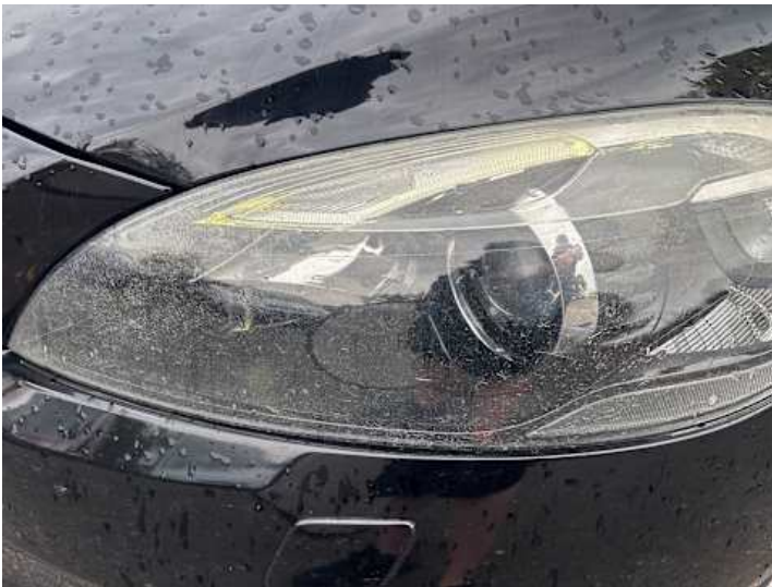
Scheinwerfer (links) (Anderer Schaden): Rissig
