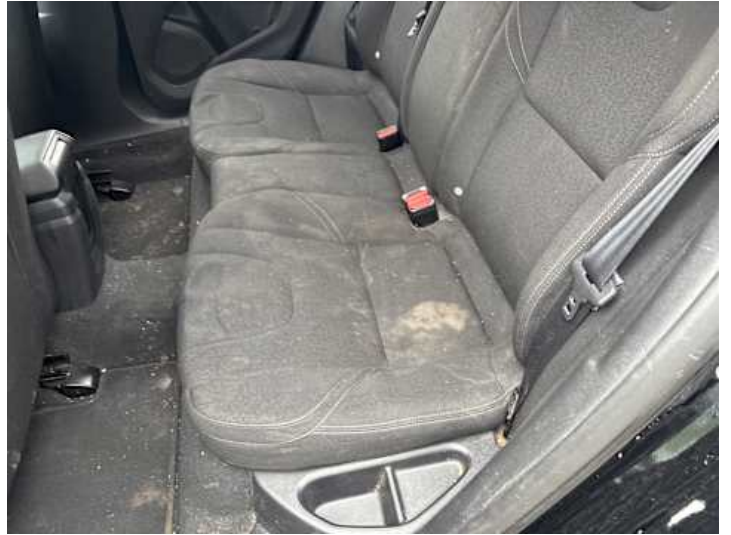
Innenraum (Verschmutzung, Verschleiß)
