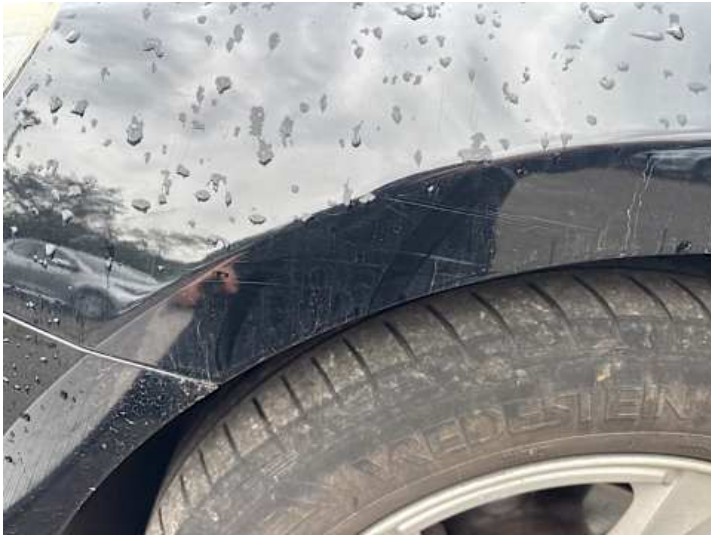
Kotflügel vorne links (Kratzer)
