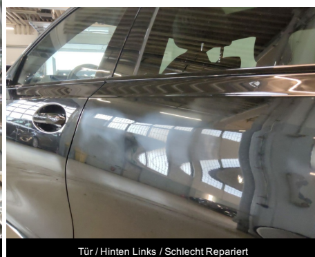
Tür / Hinten Links / Schlecht Repariert
