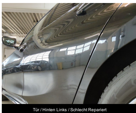
Tür / Hinten Links / Schlecht Repariert
