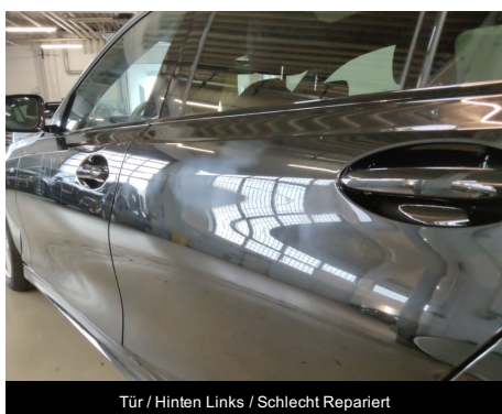
Tür / Hinten Links / Schlecht Repariert
