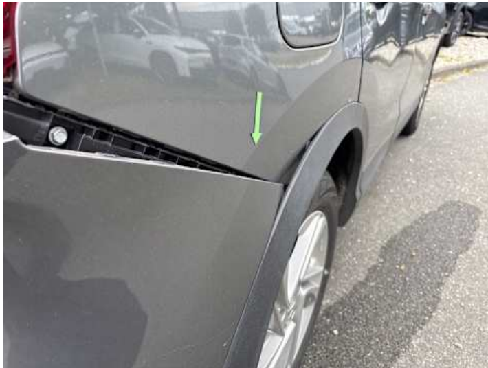
Seitenteil hinten rechts (Verformung)
