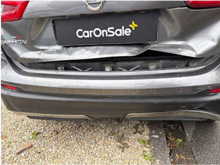
Stoßstange hinten (Lackschaden, Riss/Bruch, Spaltmaße ungenau)
