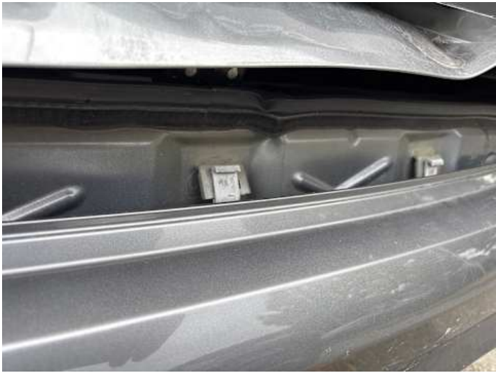
Stoßstange hinten (Lackschaden, Riss/Bruch, Spaltmaße ungenau)
