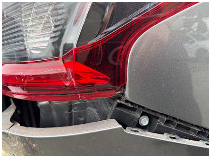
Rücklicht (rechts) (Riss/Bruch, Kratzer)
