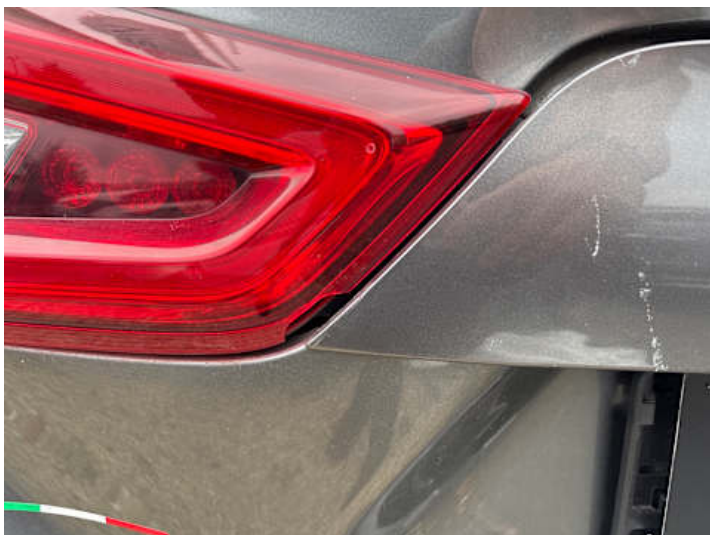
Rücklicht (links) (Riss/Bruch, Kratzer)
