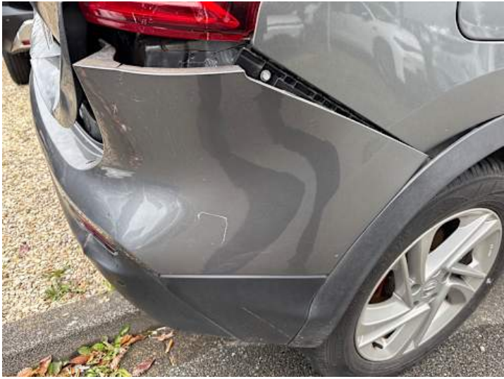
Stoßstange hinten (Lackschaden, Riss/Bruch, Spaltmaße ungenau)
