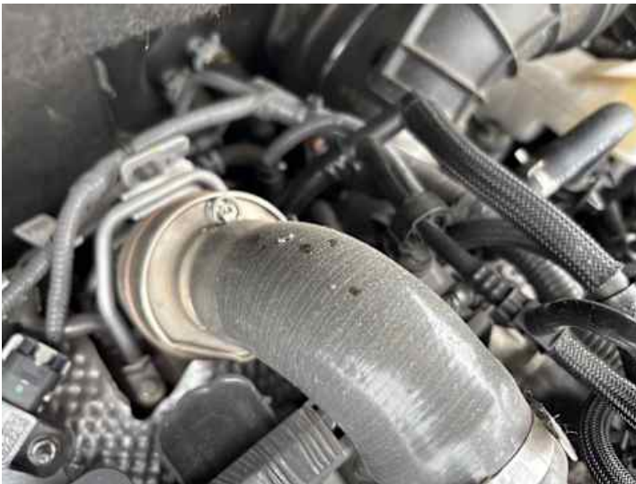
Innenraum (Riss/Bruch, Anderer Schaden): Turboladerschlauch beschädigt
