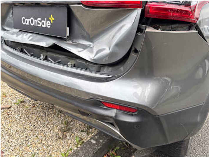
Stoßstange hinten (Lackschaden, Riss/Bruch, Spaltmaße ungenau)
