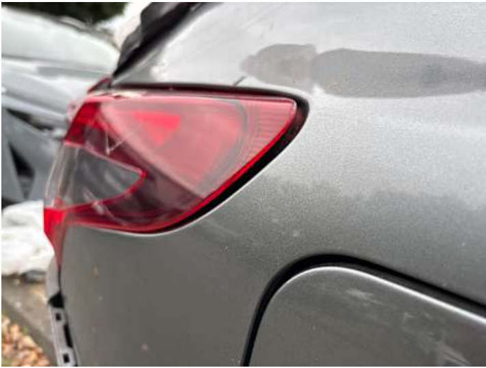
Rücklicht (rechts) (Riss/Bruch, Kratzer)
