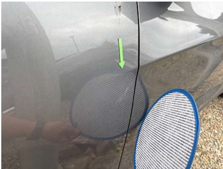
Kotflügel vorne links (Kratzer, Lackschaden, Delle)
