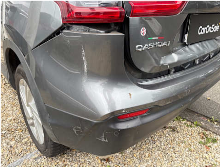
Stoßstange hinten (Lackschaden, Riss/Bruch, Spaltmaße ungenau)
