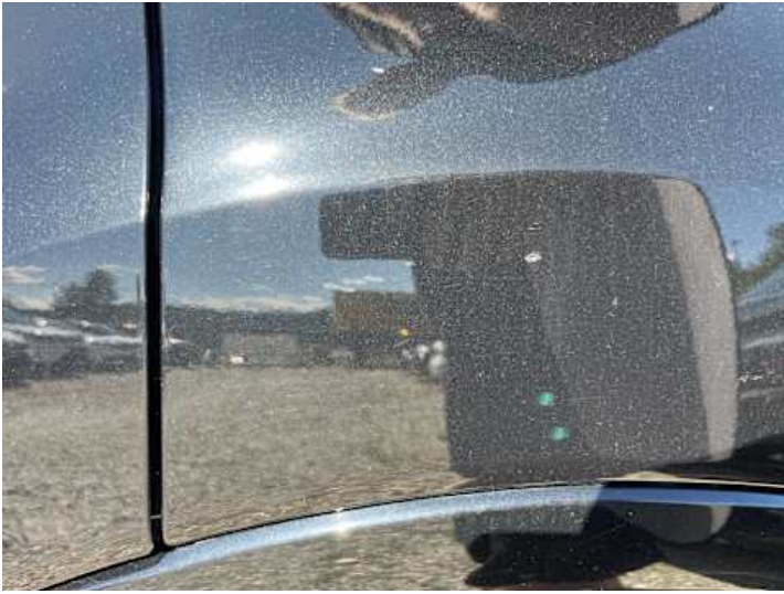
Seitenteil hinten links (Lackschaden, Kratzer)
