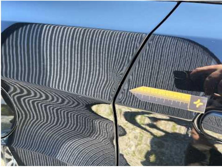
Seitenteil hinten rechts (Lackschaden, Delle)
