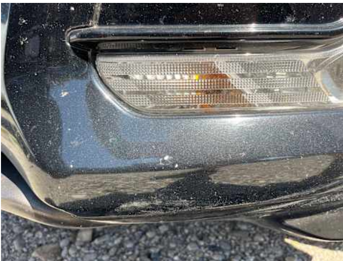
Stoßstange vorne (Lackschaden, Steinschlag)
