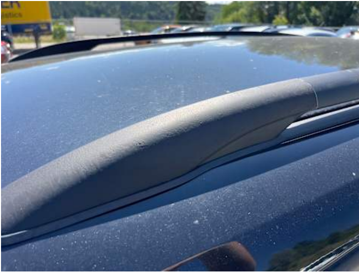
Seitenteil hinten rechts (Lackschaden)
