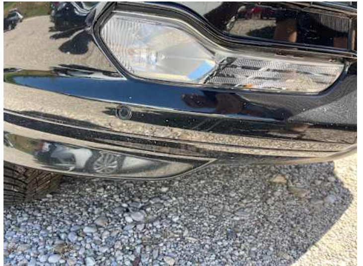
Stoßstange vorne (Lackschaden, Steinschlag)
