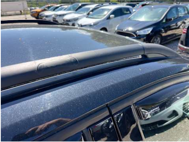
Seitenteil hinten rechts (Lackschaden)
