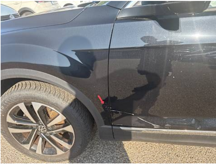
Kotflügel vorne links (Lackschaden, Delle)
