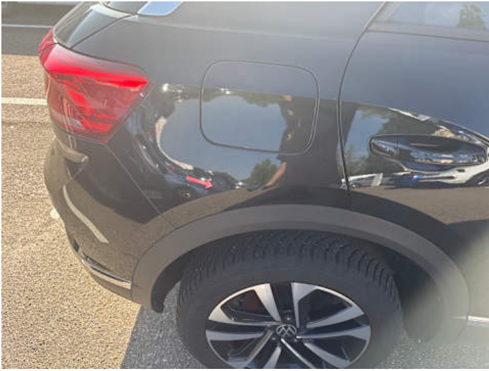
Seitenteil hinten rechts (Lackschaden, Delle)
