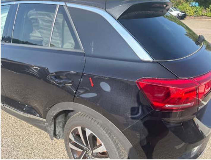
Seitenteil hinten links (Verformung)
