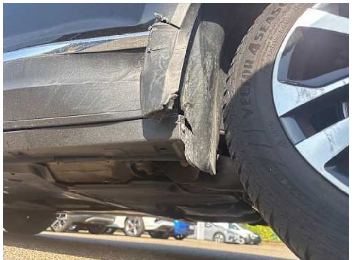
Schweller links (Riss/Bruch)
