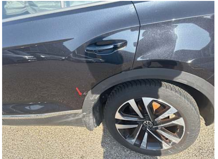
Türe hinten links (Verformung, Lackschaden, Kratzer, Riss/Bruch)
