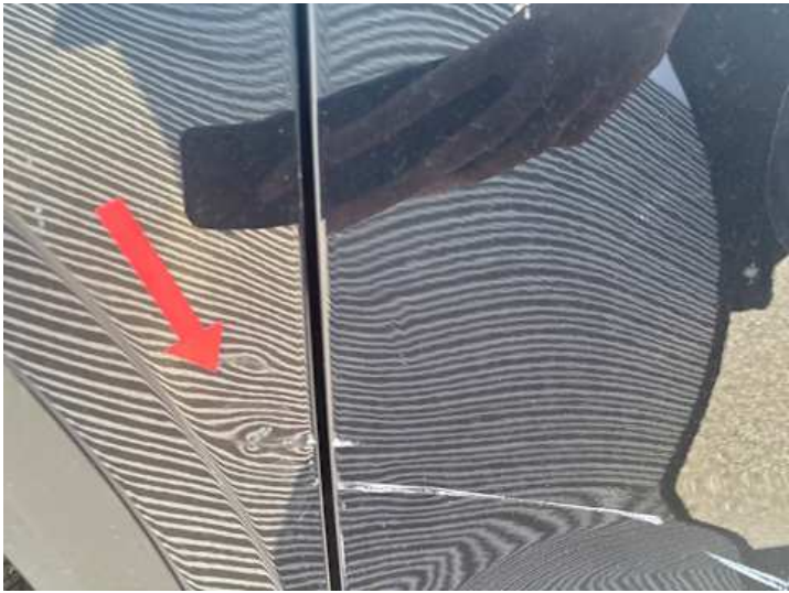
Kotflügel vorne links (Lackschaden, Delle)
