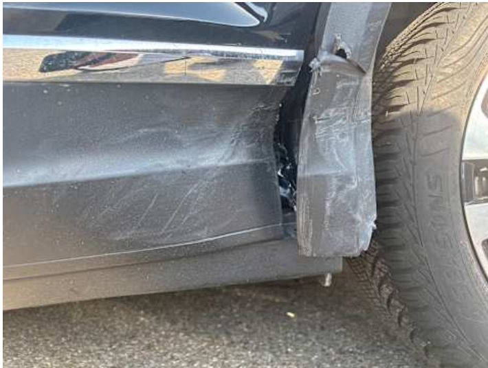
Türe hinten links (Verformung, Lackschaden, Kratzer, Riss/Bruch)
