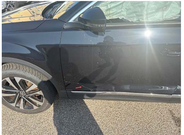
Fahrtür (Lackschaden, Kratzer)
