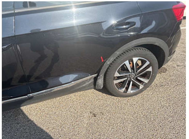
Türe hinten links (Verformung, Lackschaden, Kratzer, Riss/Bruch)
