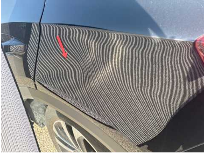
Seitenteil hinten links (Verformung)
