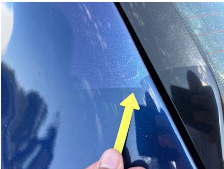
Seitenteil hinten links (Lackschaden, Kratzer)
