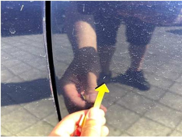
Türe hinten links (Kratzer, Delle)
