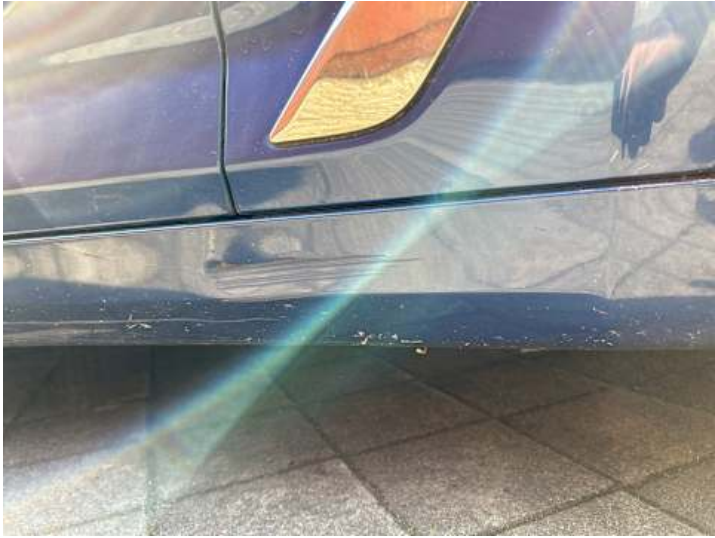
Schweller rechts (Kratzer, Verformung, Lackschaden)
