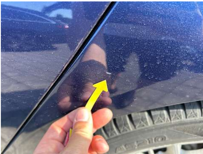
Seitenteil hinten links (Lackschaden, Kratzer)
