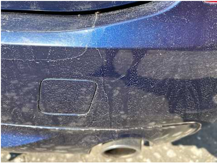
Stoßstange hinten (Kratzer, Riss/Bruch)
