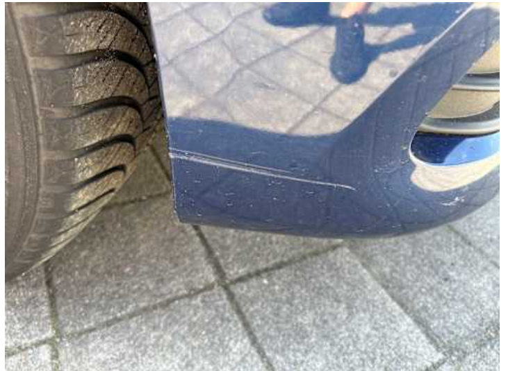
Stoßstange vorne (Kratzer, Lackschaden, Verformung)
