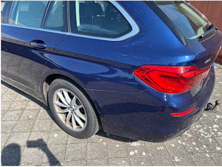
Seitenteil hinten links (Lackschaden, Kratzer)
