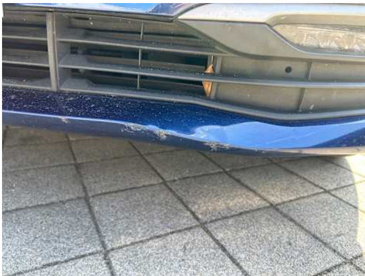
Stoßstange vorne (Kratzer, Lackschaden, Verformung)
