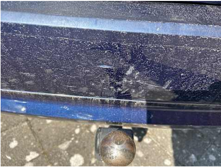
Stoßstange hinten (Kratzer, Riss/Bruch)
