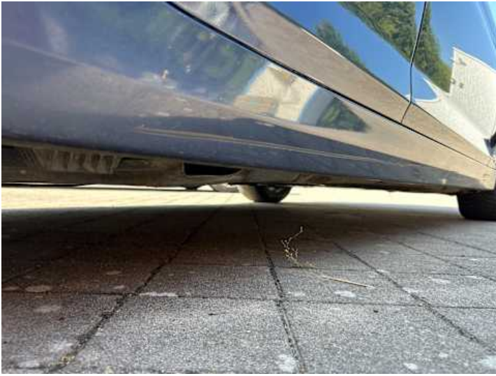
Schweller rechts (Kratzer, Verformung, Lackschaden)
