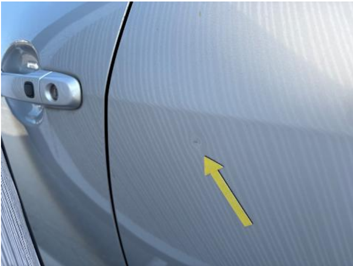
Türe hinten links (Delle, Kratzer)
