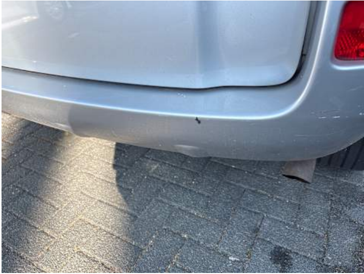
Stoßstange hinten (Kratzer)
