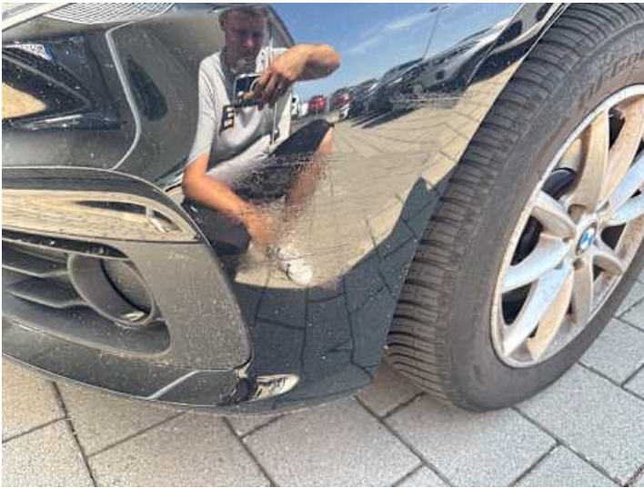
Stoßstange vorne (Unsachgemäß instand gesetzt)
