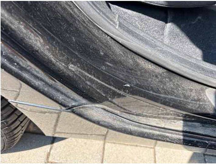
Schweller rechts (Kratzer)
