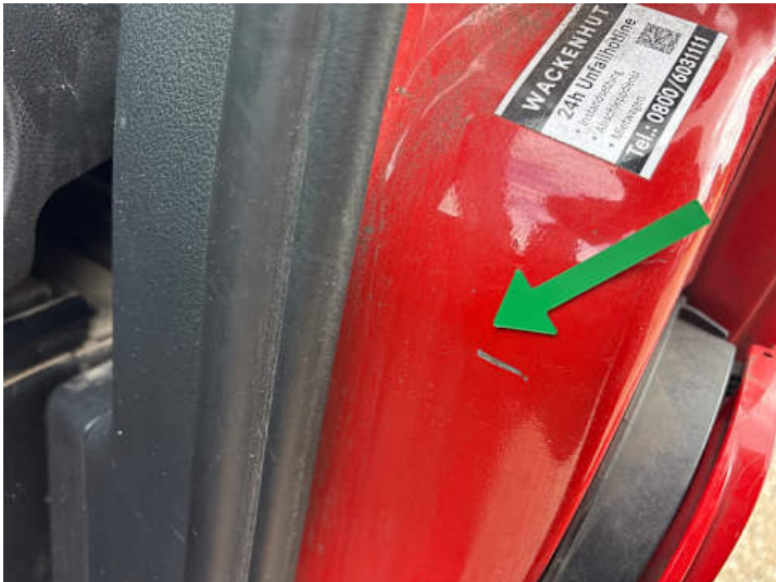
Schweller links (Kratzer)
