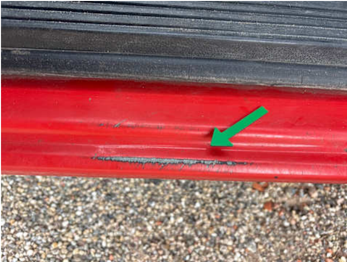
Schweller links (Kratzer)
