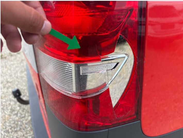
Rücklicht (rechts) (Riss/Bruch)
