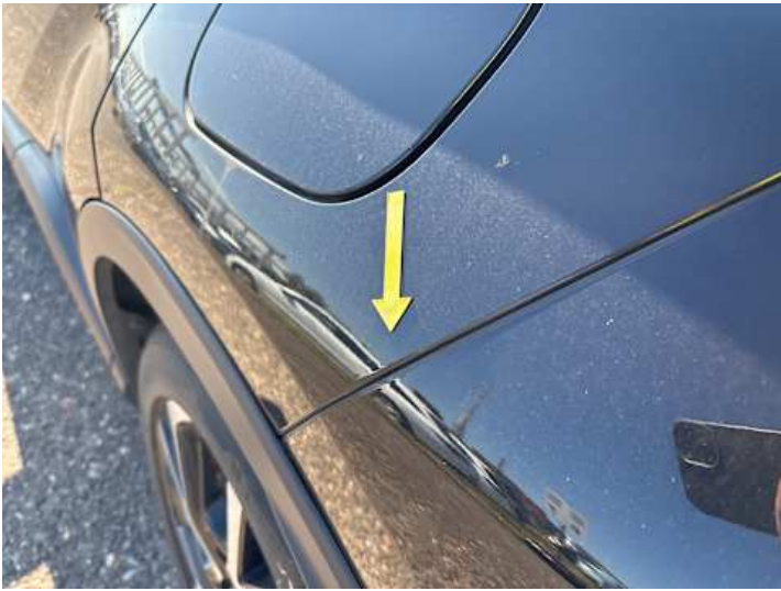
Seitenteil hinten links (Spaltmaße ungenau)
