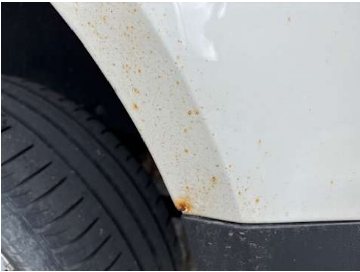
Seitenteil hinten links (Rost)
