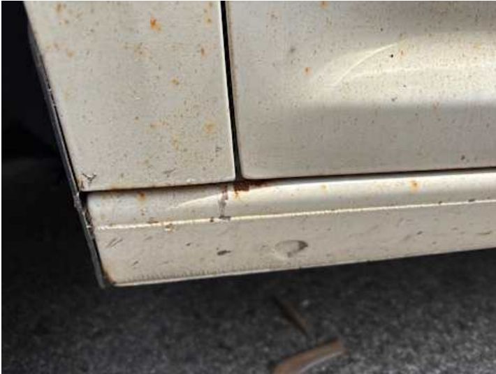
Schweller links (Rost)
