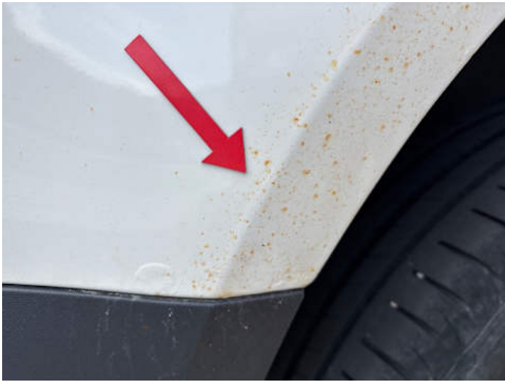
Seitenteil hinten rechts (Rost)
