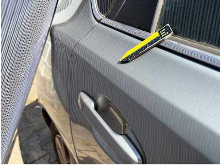
Türe hinten rechts (Delle)
