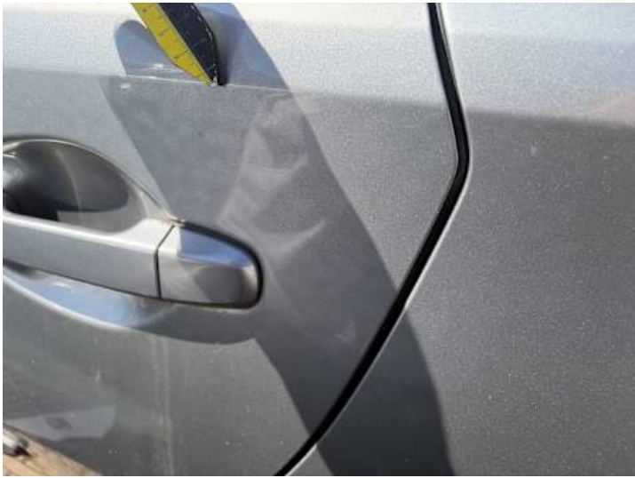
Türe hinten links (Lackschaden, Kratzer)
