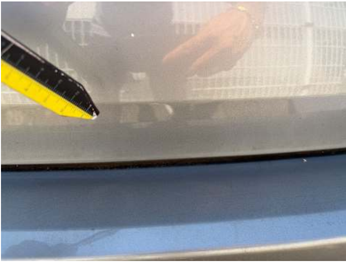
Heckklappe (Lackschaden, Kratzer)
