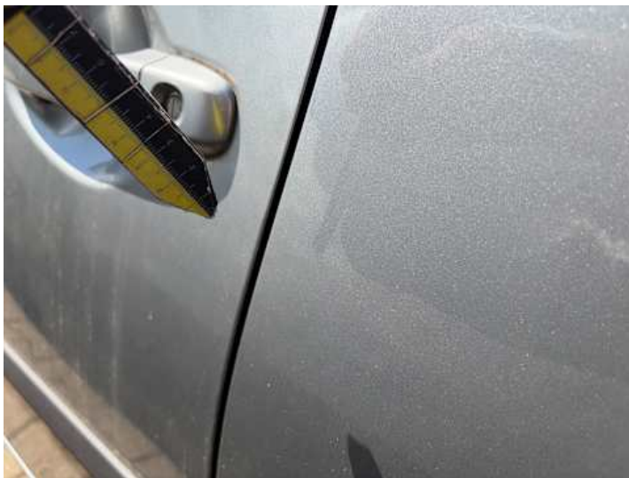
Fahrtür (Lackschaden, Kratzer)
