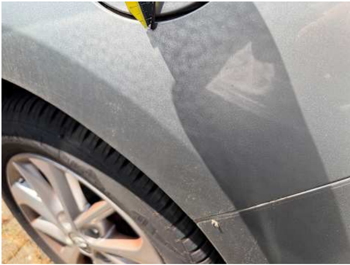
Seitenteil hinten links (Lackschaden, Kratzer)
