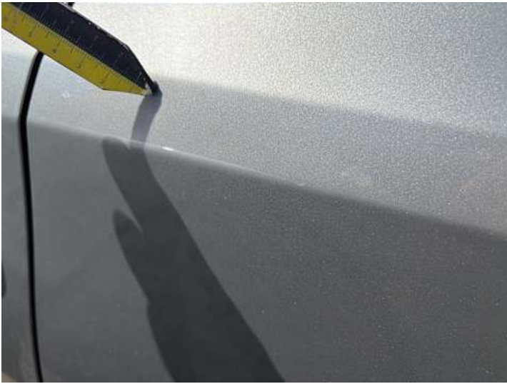
Türe hinten links (Lackschaden, Kratzer)
