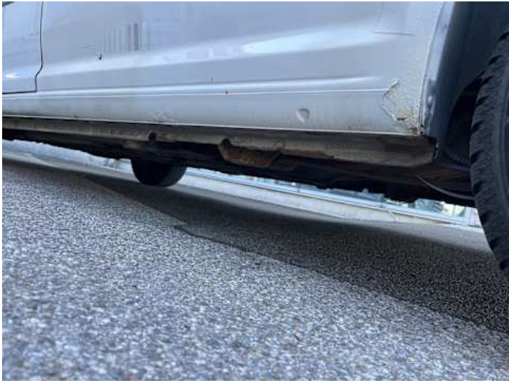
Schweller links (Rost)
