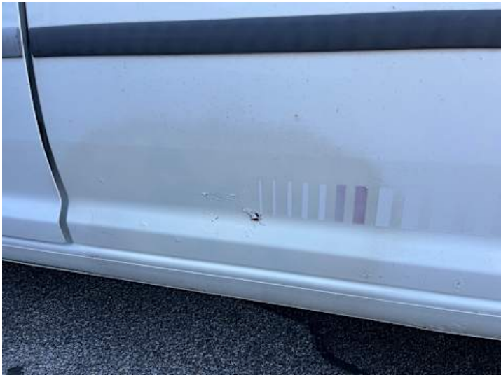
Seitenteil hinten links (Rost)
