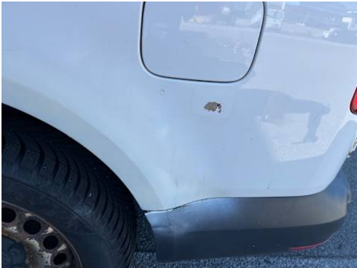
Seitenteil hinten links (Rost)
