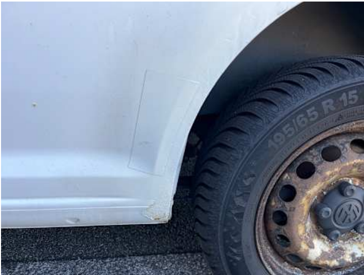
Seitenteil hinten links (Rost)
