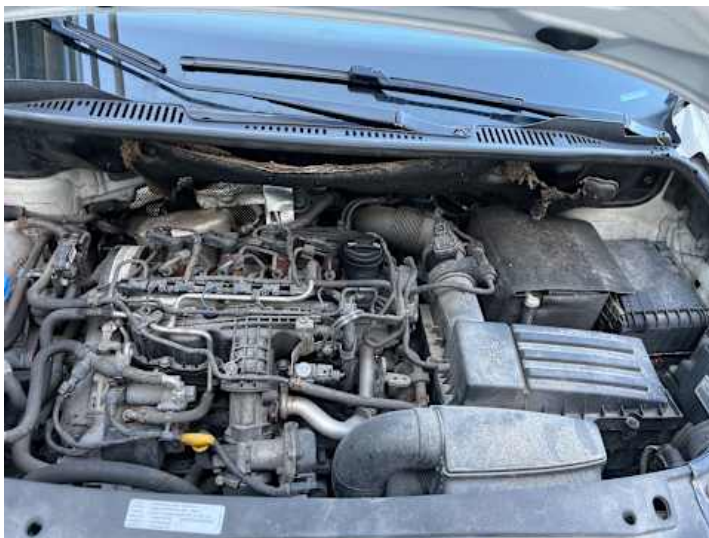
Motorhaube (Anderer Schaden): Dämmmatte beschädigt
