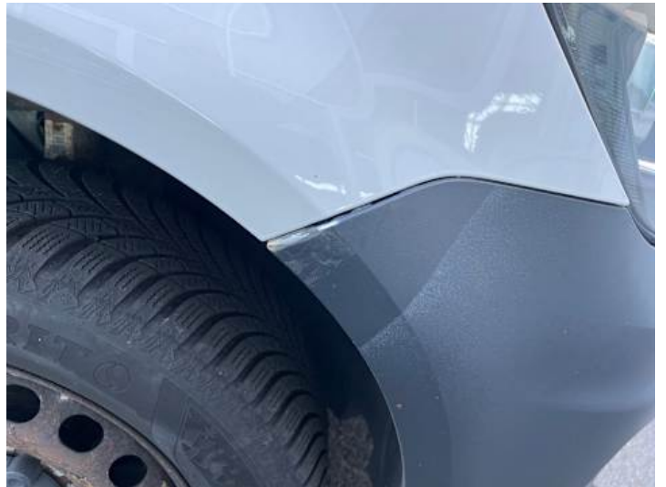
Stoßstange vorne (Spaltmaße ungenau, Anderer Schaden): Farbe
