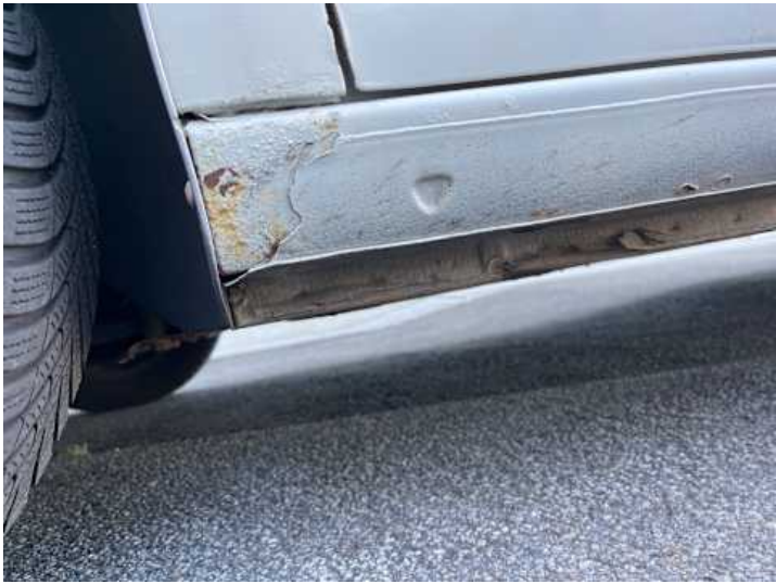
Schweller links (Rost)
