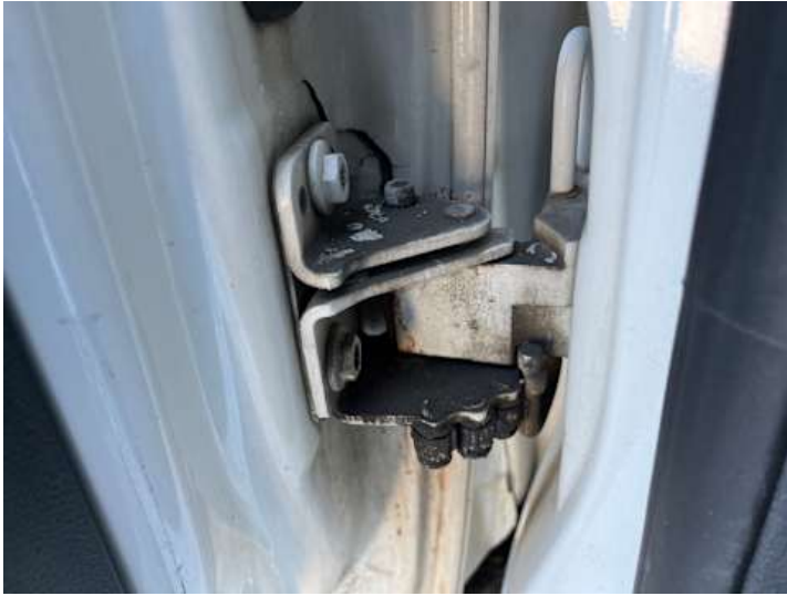
Fahrtür (Anderer Schaden): Türe hängt Schanier locker Blech eingerissen
