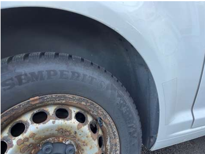
Seitenteil hinten rechts (Rost)
