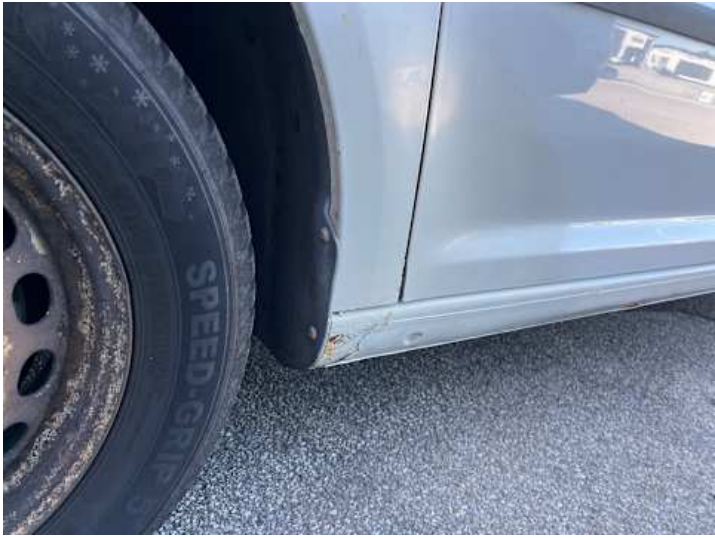
Kotflügel vorne links (Rost)
