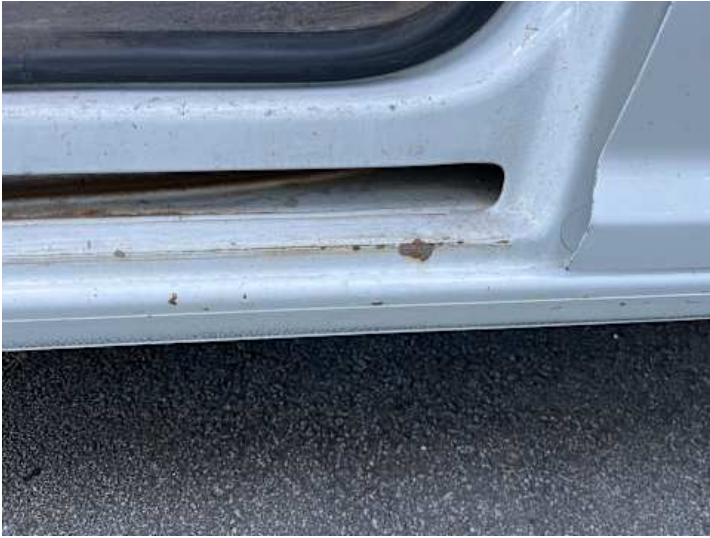
Schweller rechts (Rost)
