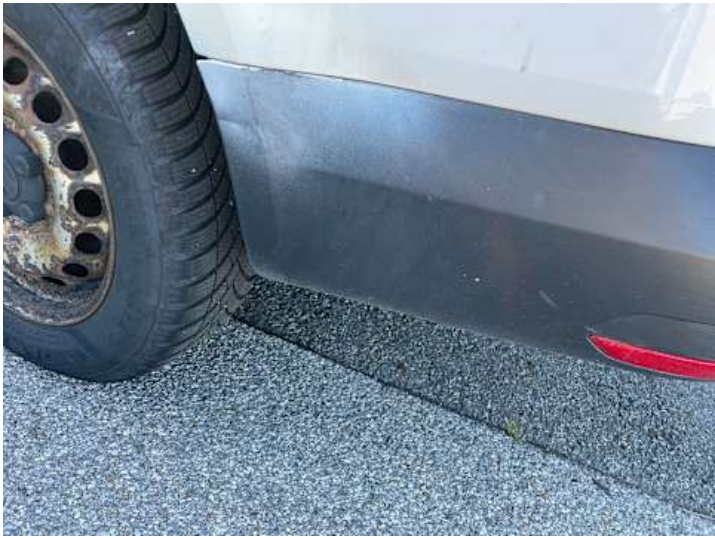
Stoßstange hinten (Anderer Schaden): Farbnebel
