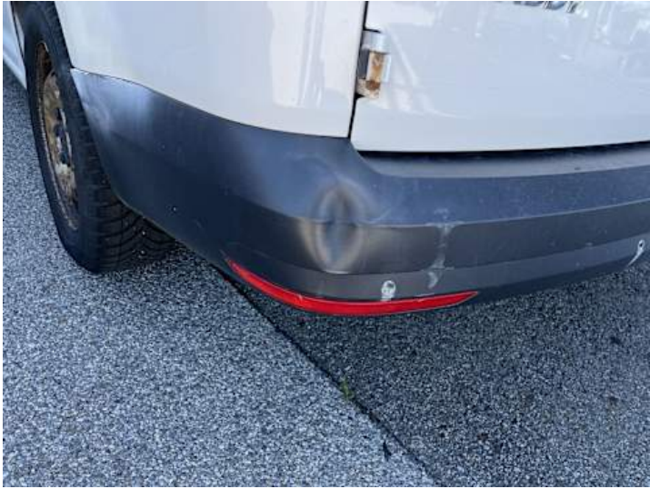
Stoßstange hinten (Riss/Bruch, Delle)
