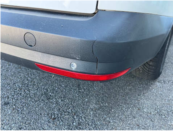
Stoßstange hinten (Riss/Bruch, Delle)
