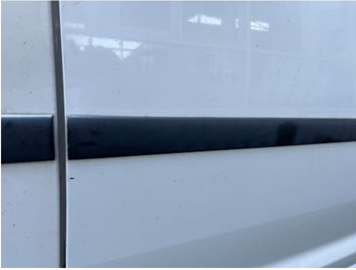
Beifahrtür (Anderer Schaden): Farbnebel
