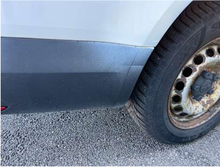
Stoßstange hinten (Anderer Schaden): Farbnebel
