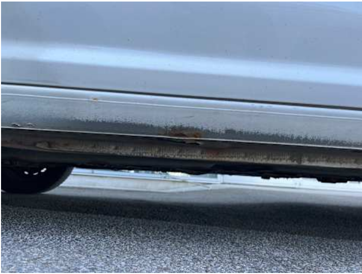
Schweller links (Rost)
